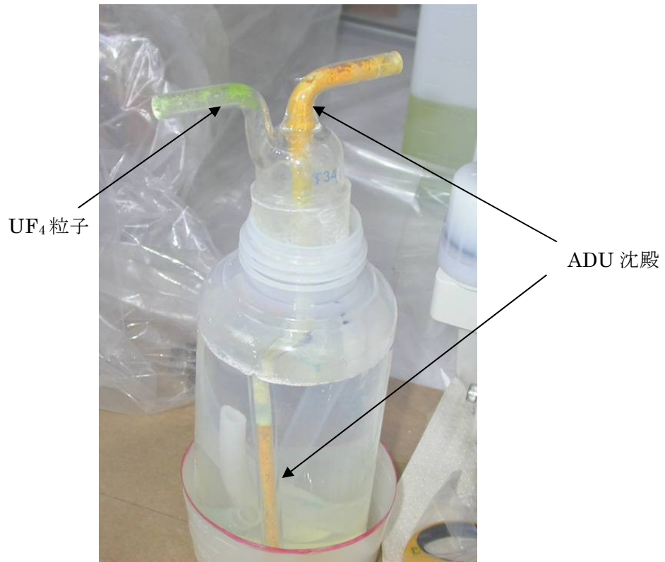
写真 3 第1トラップガラス管内に沈着した ADU 沈殿及び UF 4 粒子
