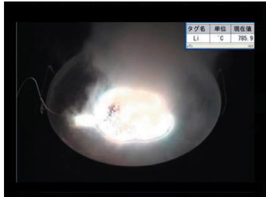
(1)リチウム燃焼(消火剤散布直前)
