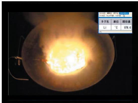
(1)リチウム燃焼(消火剤散布直前)
