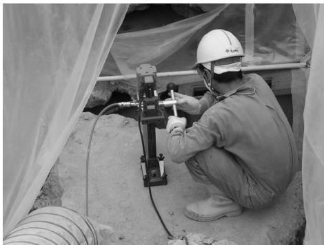
(2) コアボーリング機によるコア試料の採取状況(No.6Aピット)
