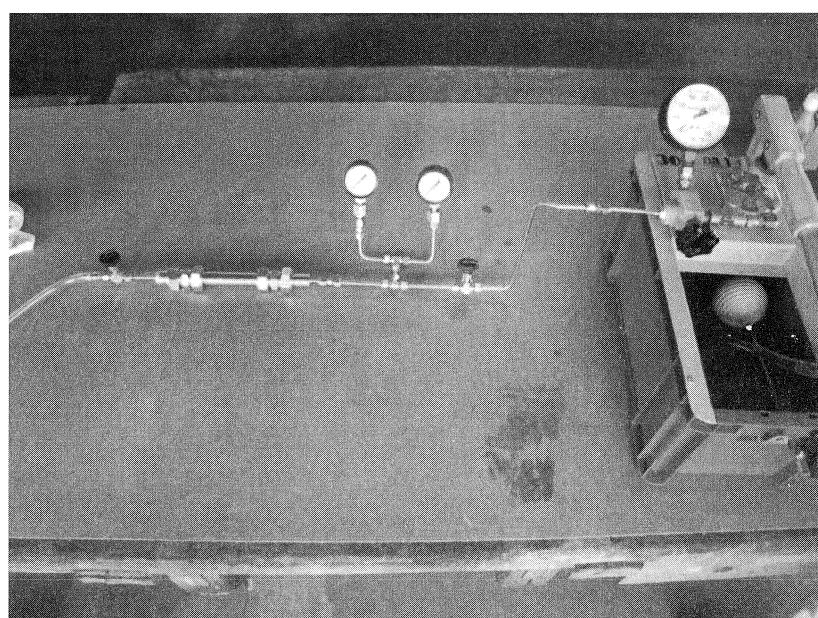
Photo.3-7 耐圧漏洩試験（外圧）状況
