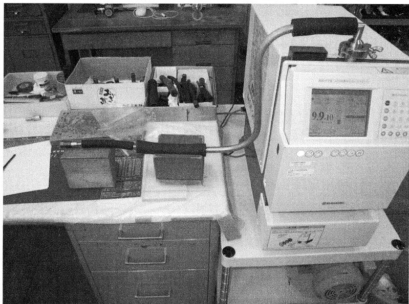
Photo.3-1 ヘリウム漏れ試験状況
