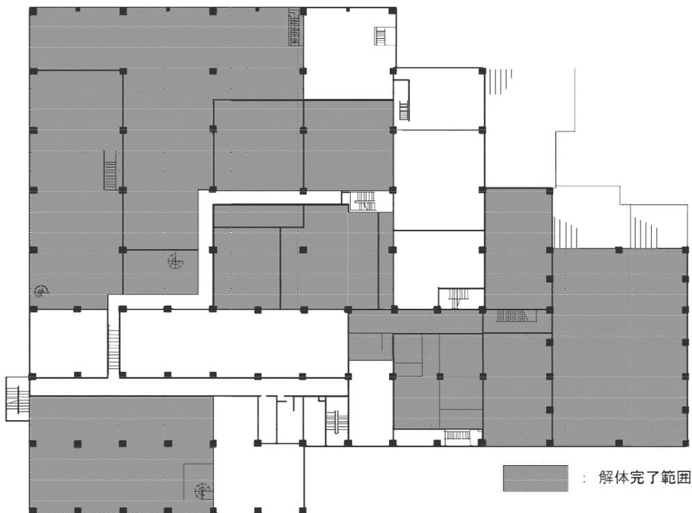
Fig.2.2-3 平成23年度末時点での製錬転換施設の仕上がり状態(2階)
