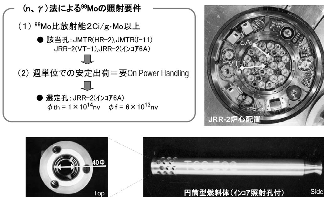
Fig.3.2-2 照射要件と照射場の選定
