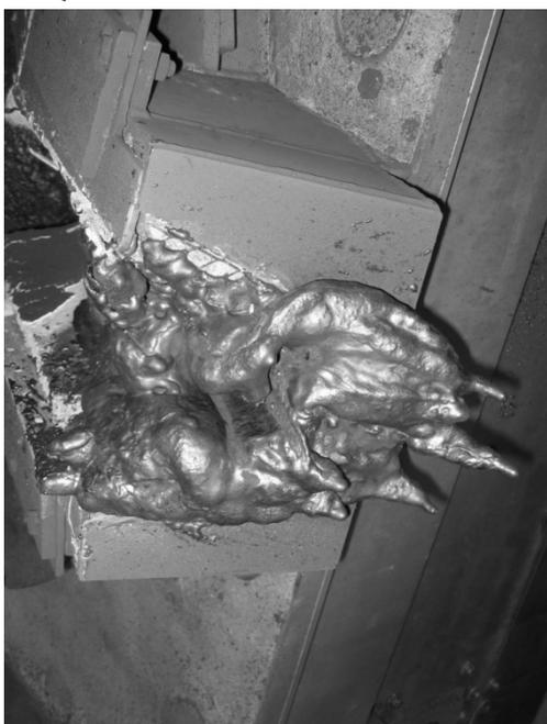
注湯機の注ぎ口での溶湯の固化、堆積の状況
