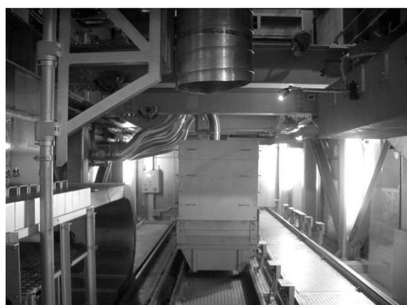
出湯流の輻射熱防止筒の設置状況
