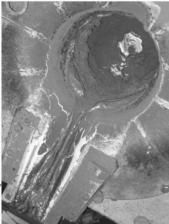
注湯機での溶湯の固化、堆積の状況
