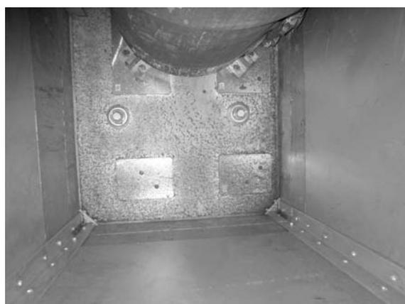
モールド台車内の飛散物
