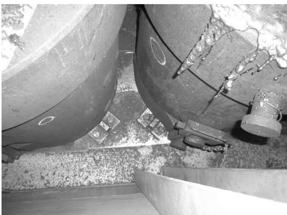
モールド台車内の飛散物
