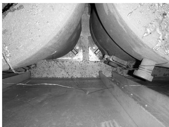
モールド台車内の飛散物
