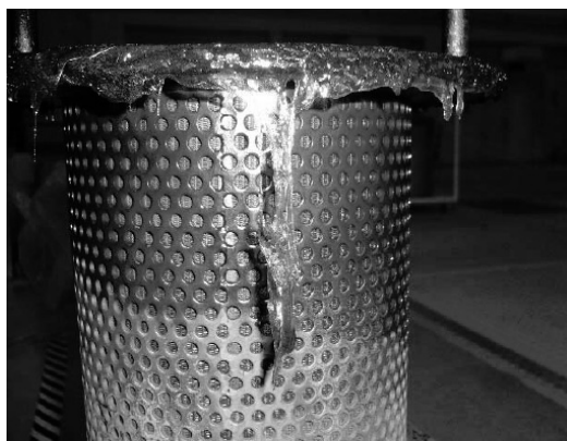
図5.2.1-2 高温フィルタ内温度低下時に付着した縮合リン酸
