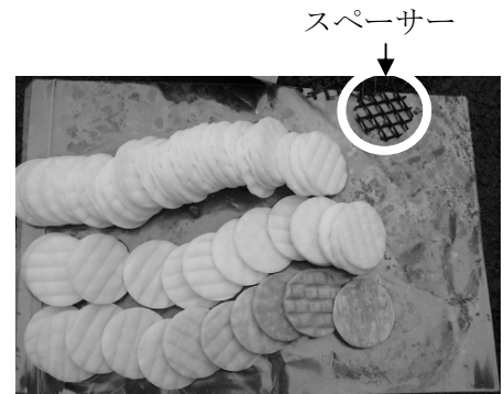
図 3.3 捕集材とスペーサー (以前の通液試験の時の写真、白丸内の網目状のものがスペーサー)
