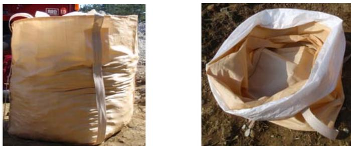
図6 クリアランス対象物を収納する保管容器（フレキシブルコンテナ）
