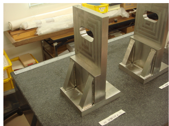
図 4.4 製作したラグ模擬体 B
