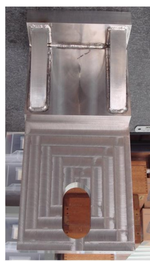
図 4.6 ラグ模擬体Bによるせん断試験方法
