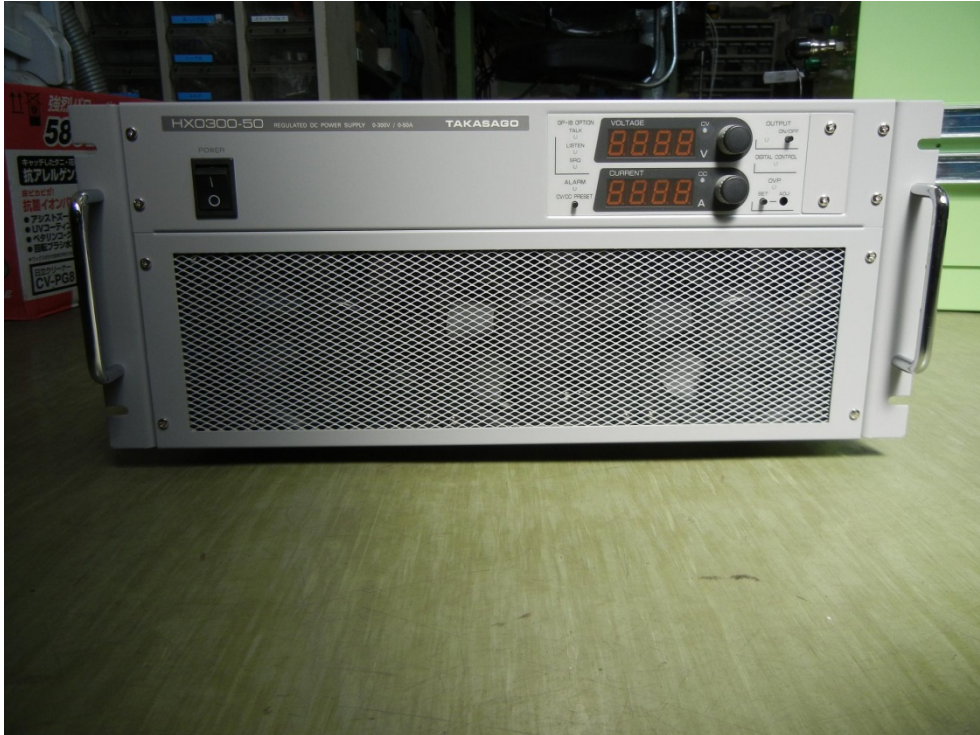
大容量ヒータ盤に使用する直流定電圧定電流源
