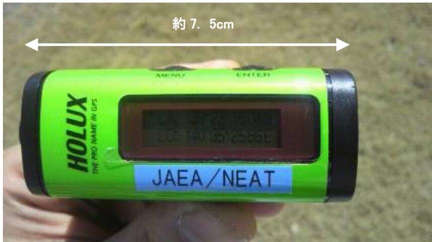
写真 3.1 GPS 測位データの取得に使用した GPS ロガー
