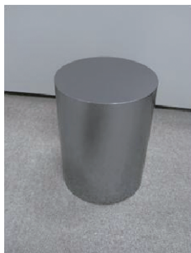
(1) Si ingot ( \phi 151\text{mm} \times 202\text{mm} )
