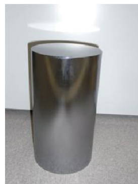
(2) Si ingot ( \phi 151\text{mm} \times 278\text{mm} )
