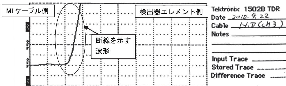
ch.3 (HV 側) の特性インピーダンス (平成 22 年 4 月 22 日)
