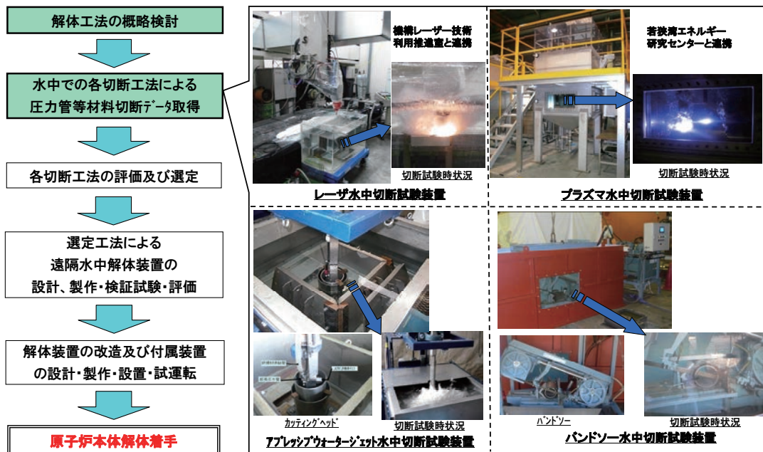
図 2.6 原子炉本体の解体作業に係る技術開発（切断データ取得）
