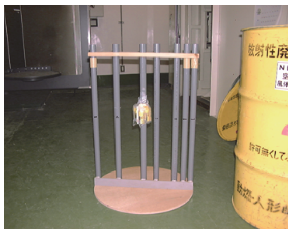
写真 4.6.1 ウラン線源の取付状況
