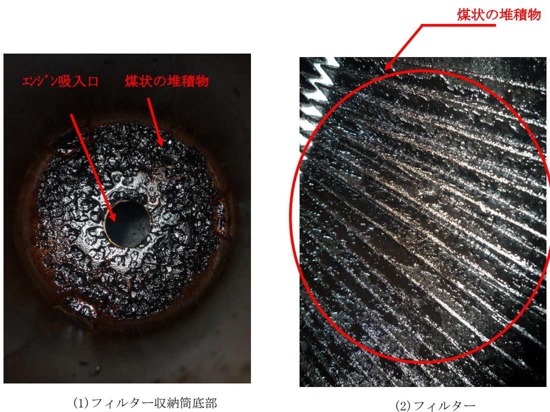
図 6.7 燃料噴射孔周辺に係る煤状の堆積物
