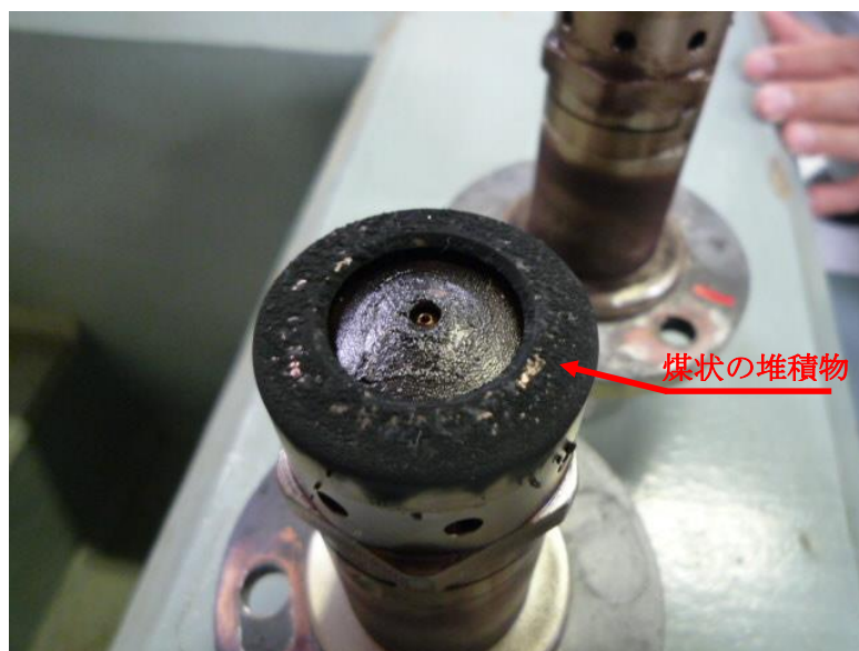
図 6.7 燃料噴射孔周辺に係る煤状の堆積物
