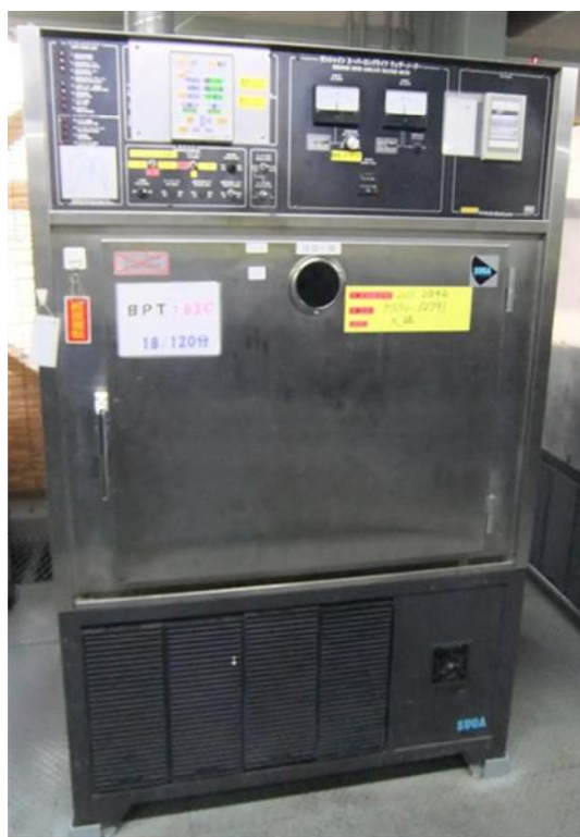
図 3.1 サンシャインウェザーメーター(WEL-SUN-HCH)外観図
