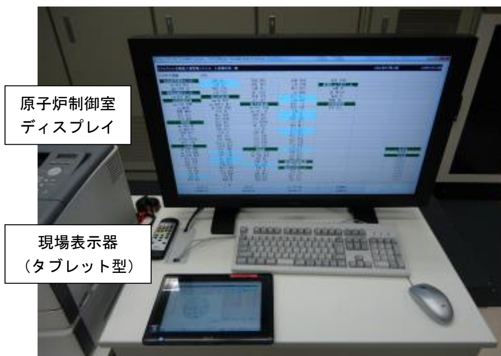
Fig 5.11 原子炉制御室ディスプレイと現場表示器 (タブレット型)
