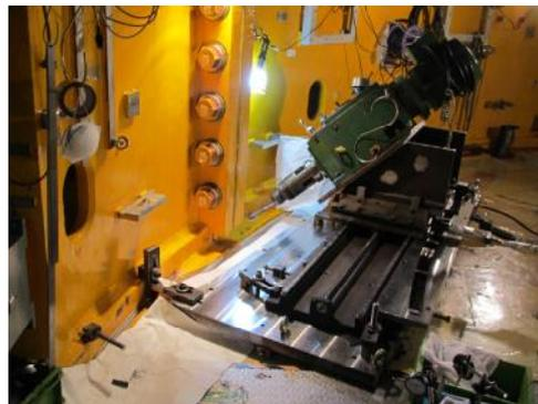
図 3.4.4-9 基礎架台内側補強溶接部
