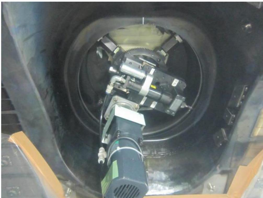
図 3.3.4.1-3 回転ポートフライスを用いた斜めポートの切削状況
