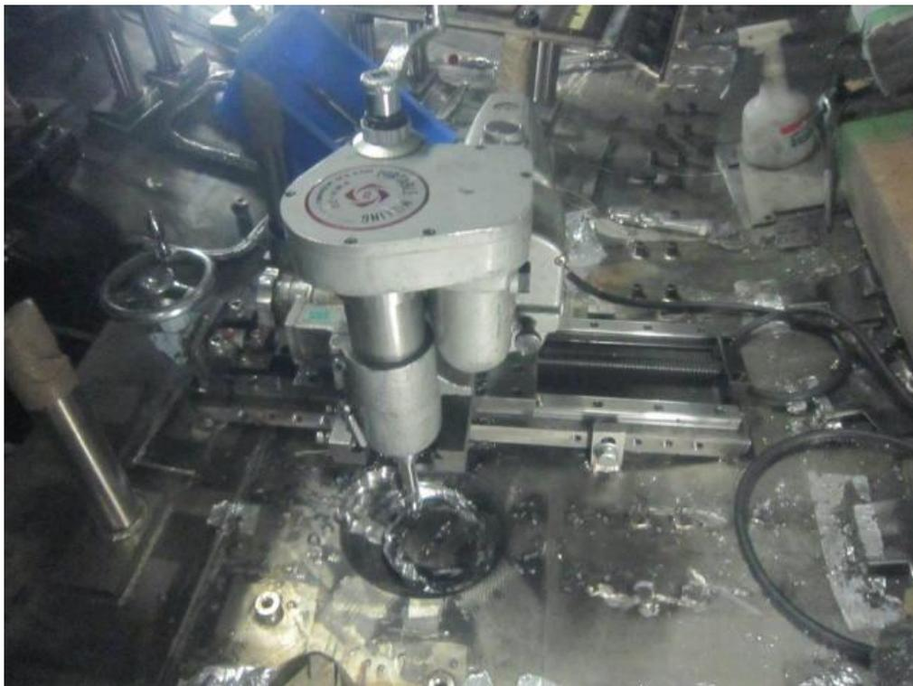
図 3.3.4.1-5 ポータブルフライスを用いた下側垂直ポートの切削状況
