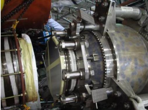
図 4.7.4-5 ポートと絶縁継手の切離し
