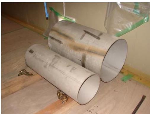
図 4.2.2-13 TF コイル冷却配管切断品
