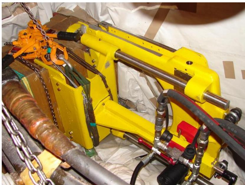
図 3.2.3.1-1 ギロチンソーによるV1 コイルの切断
