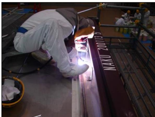
図 17 密閉容器の密閉措置（溶接）作業写真
