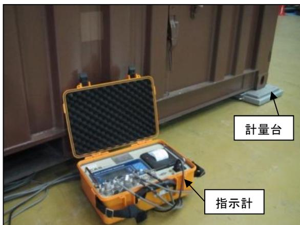
(4) ポータブル重量計による重量計測
