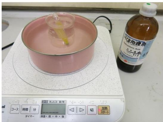
図 5.2-7 試料の塩酸処理（煮沸中）
