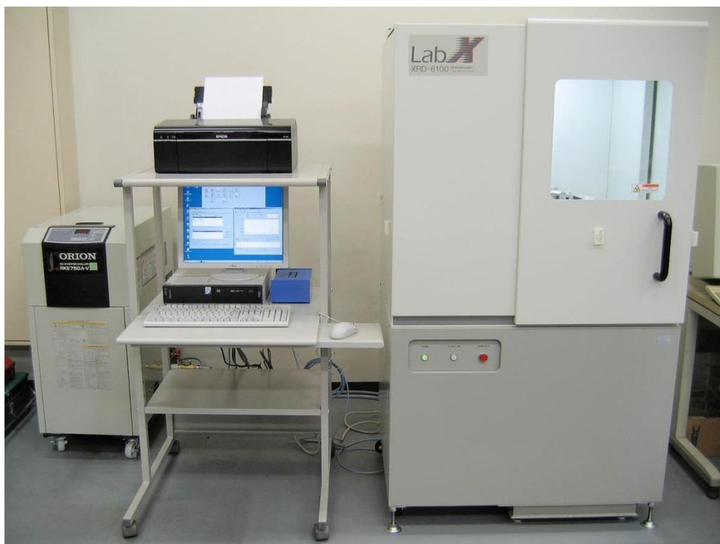
図 5.3-1 X線回折分析装置（株式会社島津製作所製 XRD-6100）
