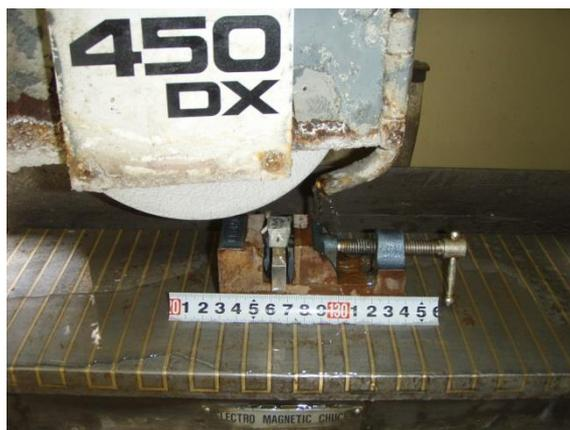
図 4.2-5 平面研削盤による研磨状況例
