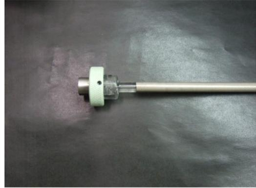
図 4.3.2-4 セルに試料をセットした状態
