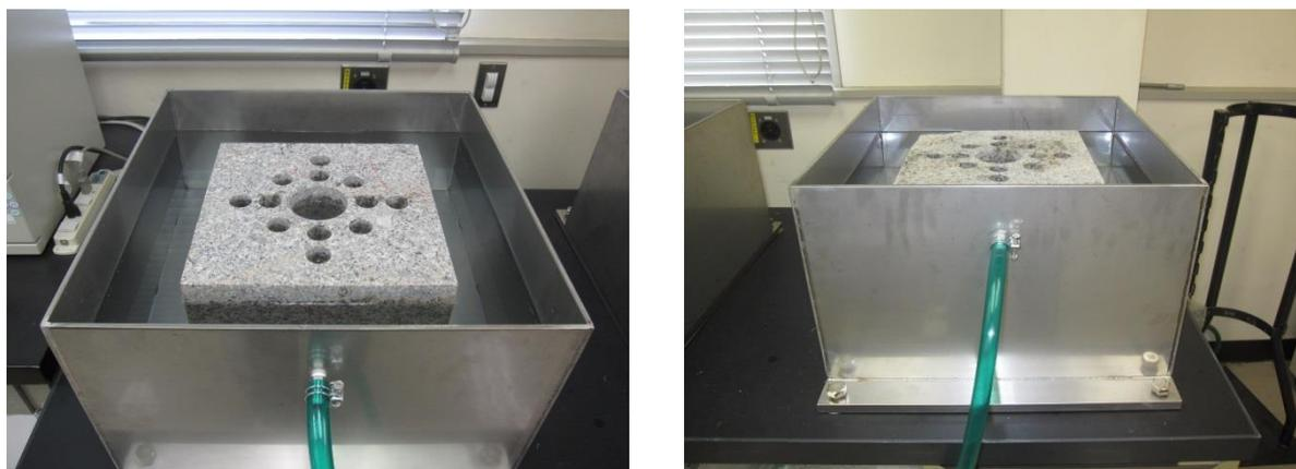
図 3.2.4-4 岩石ブロックを用いた拡散試験装置
