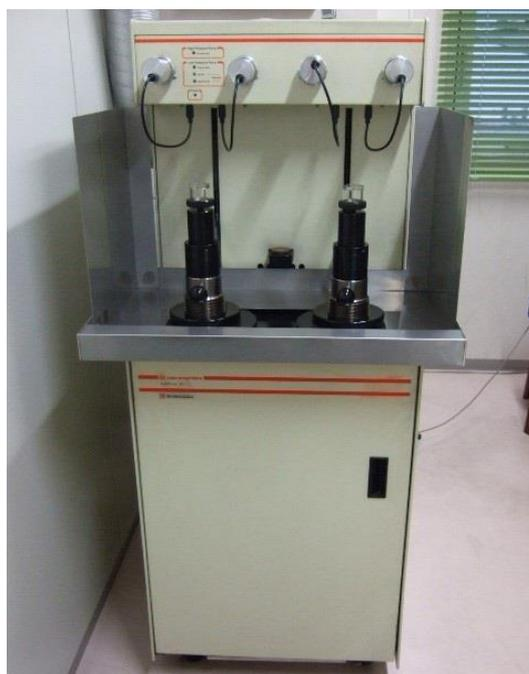
図 4.3.2-2 水銀圧入法による間隙率測定装置 (オートポア IV9520)
