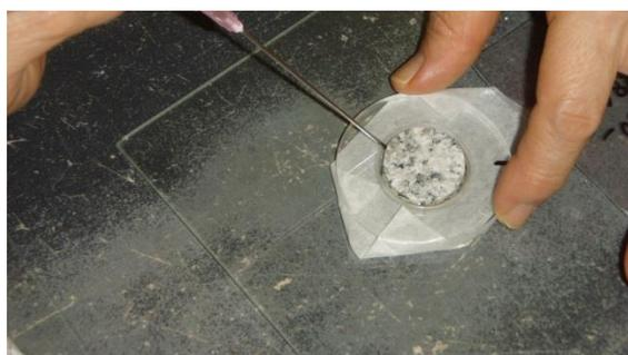
図 3.1.3-2 2液性樹脂による試料の固定
