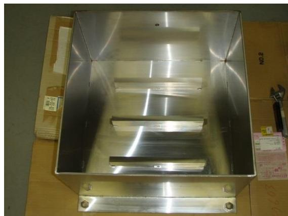
図 3.2.4-3 岩石ブロックを浸水させるための容器
