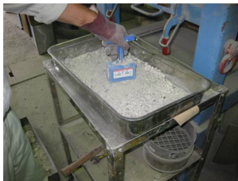
図 3-1 磁石を用いた除鉄の様子
