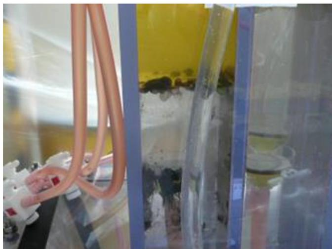
写真 11 混合処理廃液の黒色浮遊物発生状況
