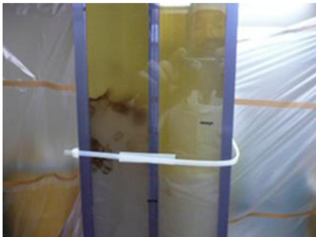
写真 9 ケーシング処理廃液の黒色浮遊物発生状況
