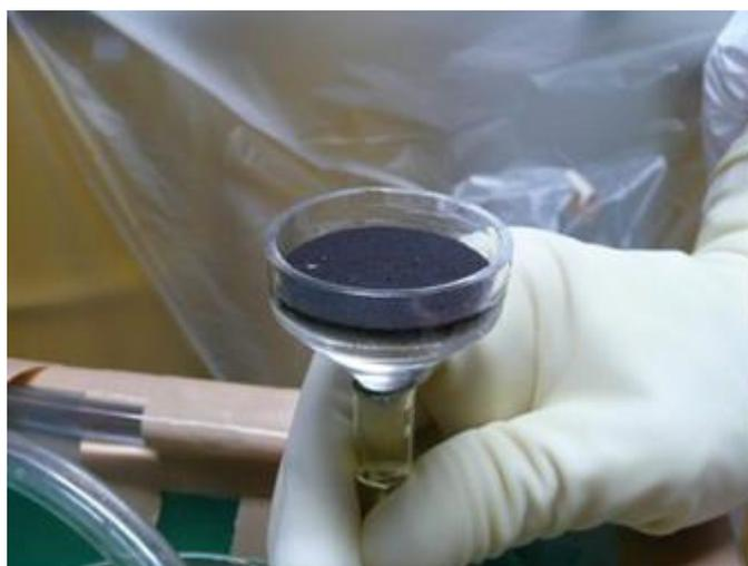
写真 12 硫酸廃液吸入部のフィルター部黒色付着物
