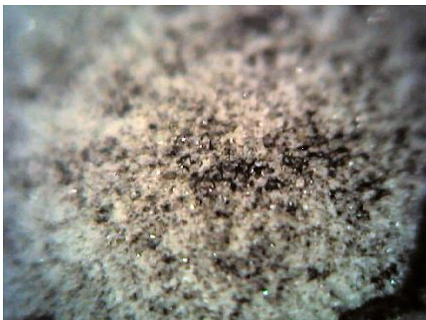
写真 16 CCD によるフィルター材黒色付着物観察結果
