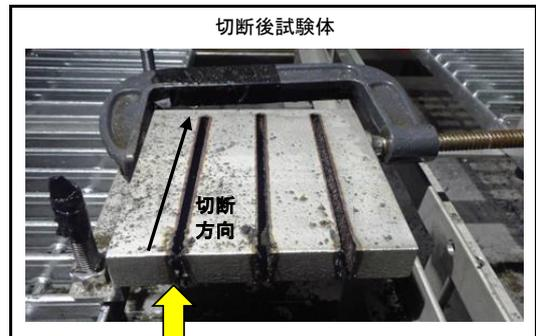
プラズマアーク切断試験 試験条件・結果
