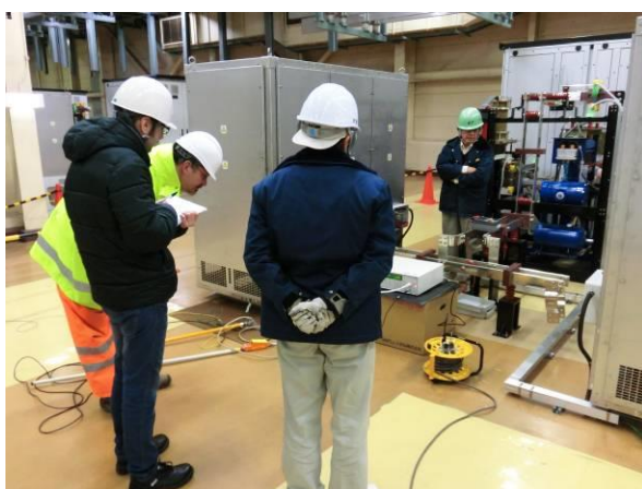
図 26 耐電圧試験（QPC 主回路一括）
