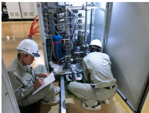
図 29 耐水圧試験（系統一括）
