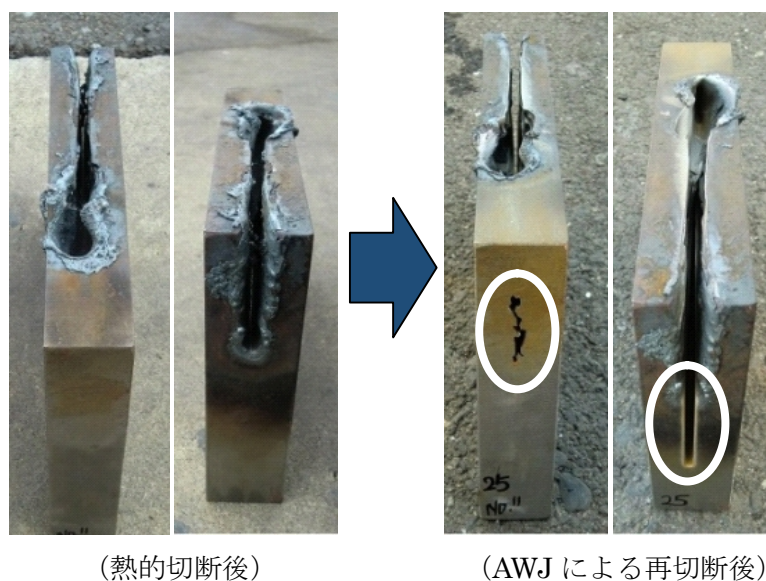
図 9 熱的切断後の AWJ 切断工法による再切断
