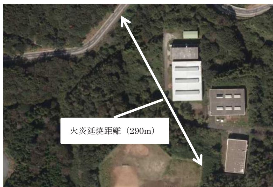
Fig.6.2 設定した火炎延焼距離（国土地理院の地図 16) を加工して作成）
