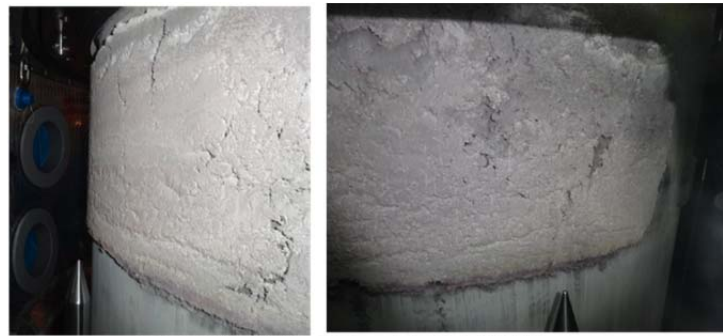
炉心上部機構制御棒取付板下のナトリウム付着状況
