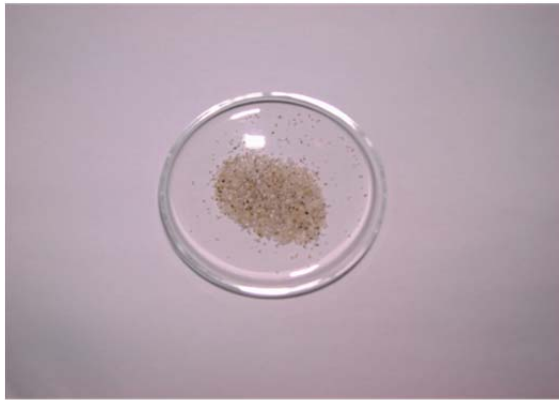
スーパーサイフォンフィルタに充填している使用前のろ過砂(H8.8)
