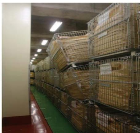
(ボックスパレットの破損)
