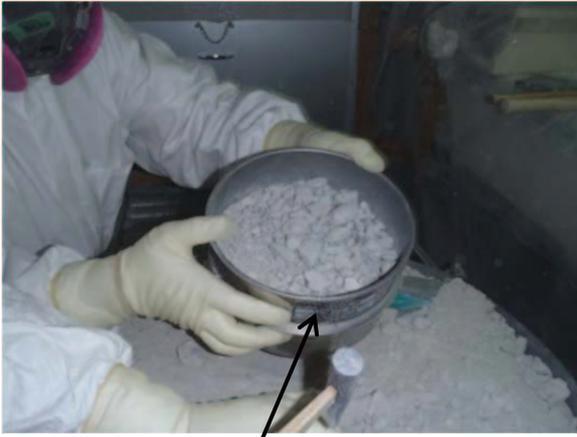
ふるいによる $\gamma$ 線測定試料の粒度調整
