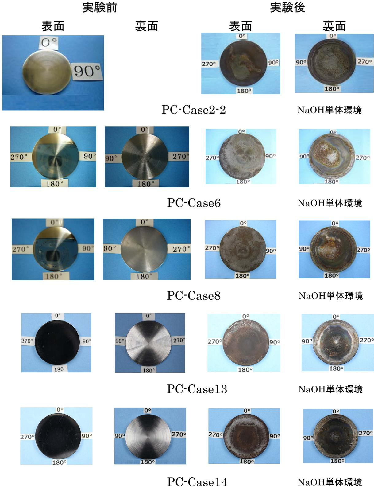
図 32 実験前後の供試体外観(試料/供試体温度 800°C)(1/3)
