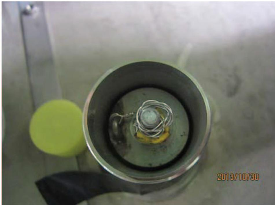
写真 5-37 異物混入防止プラグ挿入状態
