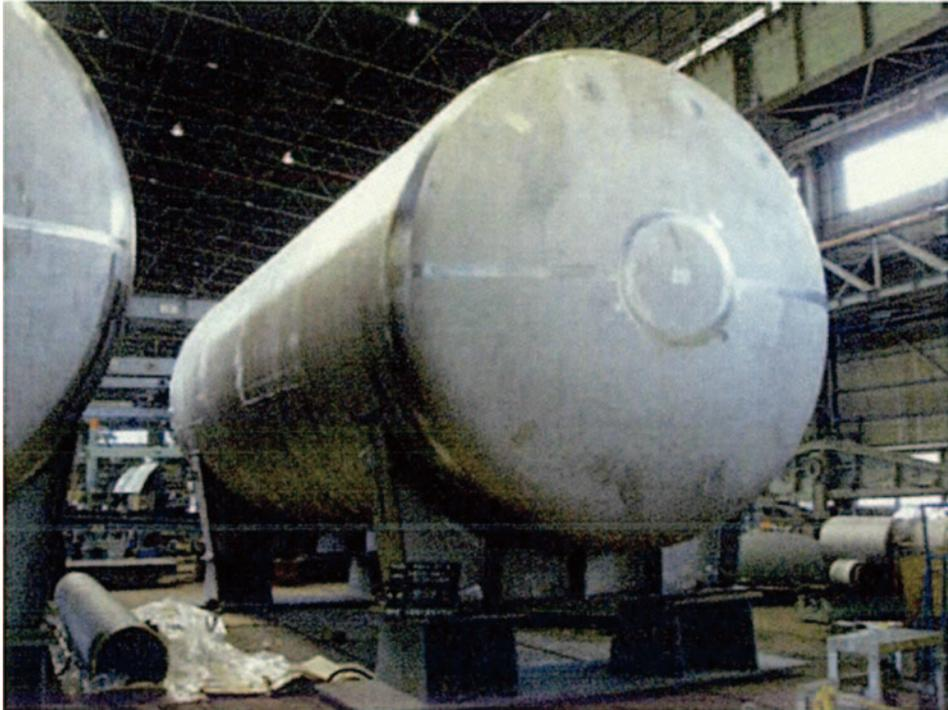
写真 4-18 ダンプタンク 1 製作完了
