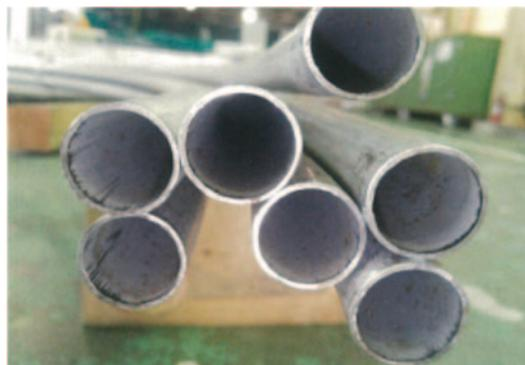
写真 4-36 エコノマイザ伝熱管内面状態
