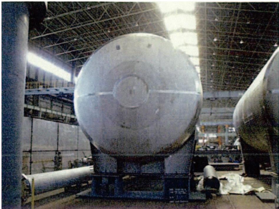
写真 4-19 ダンプタンク 2 製作完了
