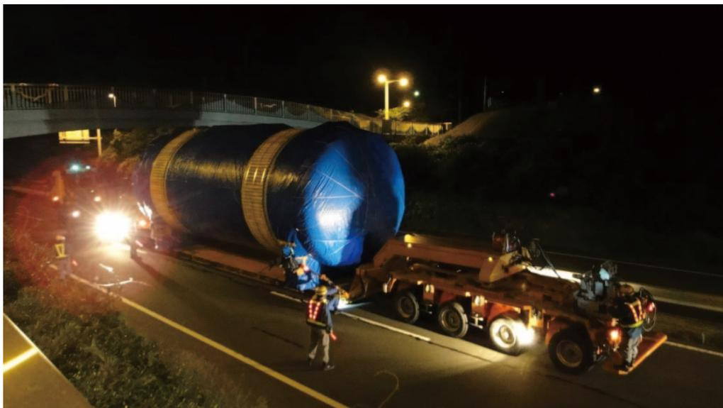
写真 4-78 ダンプタンク陸上輸送状況（国道 51 号線夏海歩道橋通過中）
