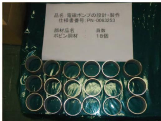
写真 4-21 電磁ポンプコイル巻き付け用
