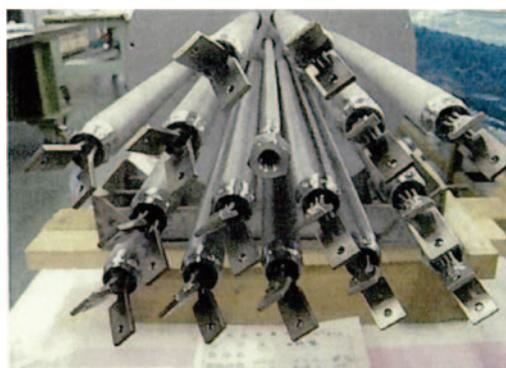
写真 4-44 戻り加熱器内部ヒータ
