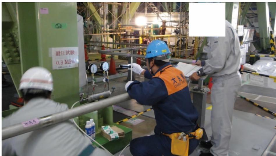
写真 5-40 大洗消防本部による立会検査（耐圧検査）
