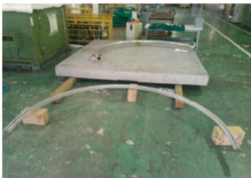
写真 4-35 エコノマイザ伝熱管外観
