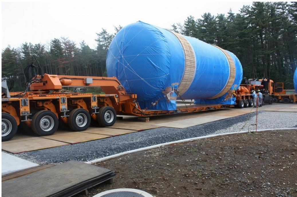
写真 4-81 斜度改善後におけるダンプタンクのトレーラ積載状況
