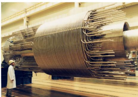
写真7-5 蒸気発生器過熱器管束部
