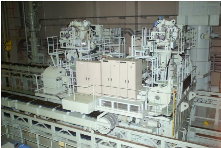
写真7-6 燃料出入機概観
