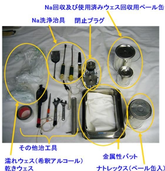
図8-1 ナトリウム洗浄治工具類の例 (物理的方法)
