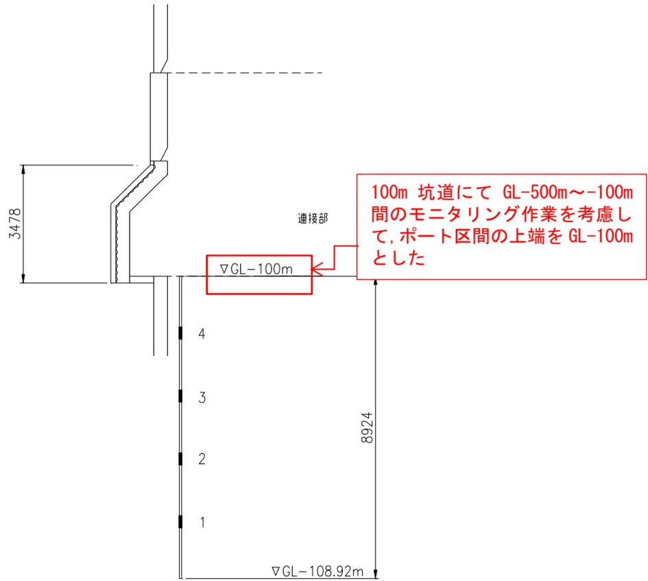
図 2-24 GL-100m ステージのポート区間設置概念図
