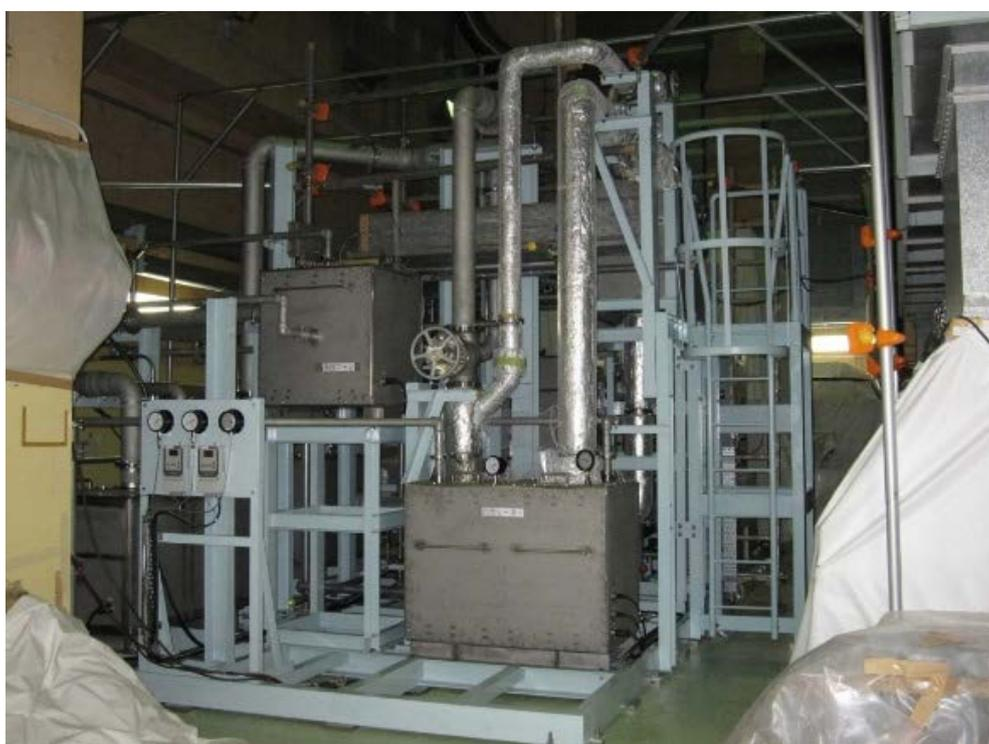
図 3.3-1 除湿ロータ式トリチウム除去装置の外観
