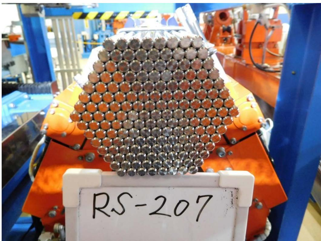
図 49 模擬燃料要素組込確認の様子 3
