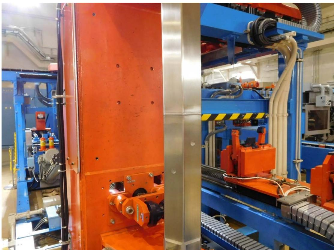
図 61 ラップ管・エントランスノズル溶接の様子 6
