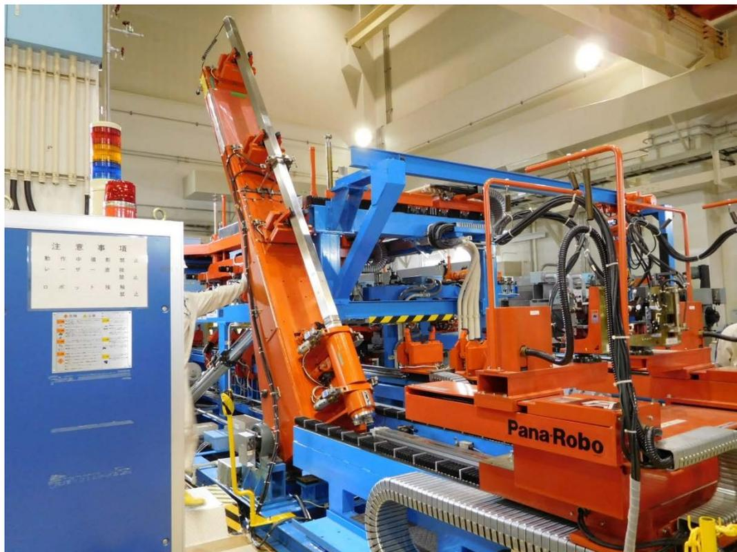
図 56 ラップ管・エントランスノズル溶接の様子 1
