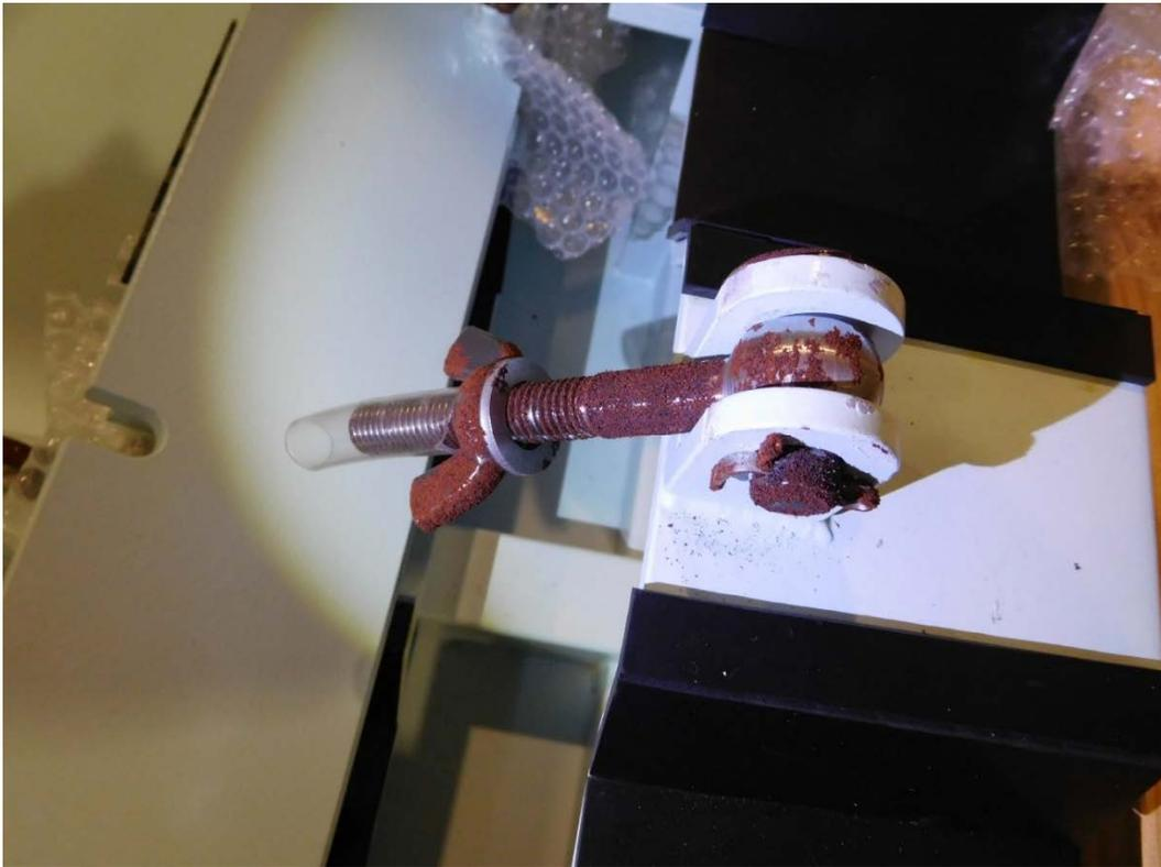
図 66 収納容器内の確認の様子（蝶ネジの錆確認）
