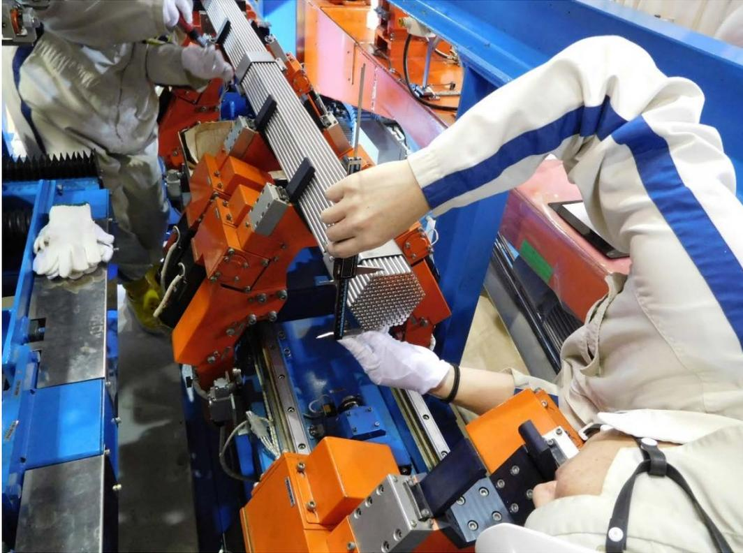
図 50 模擬燃料要素組込確認の様子 4
