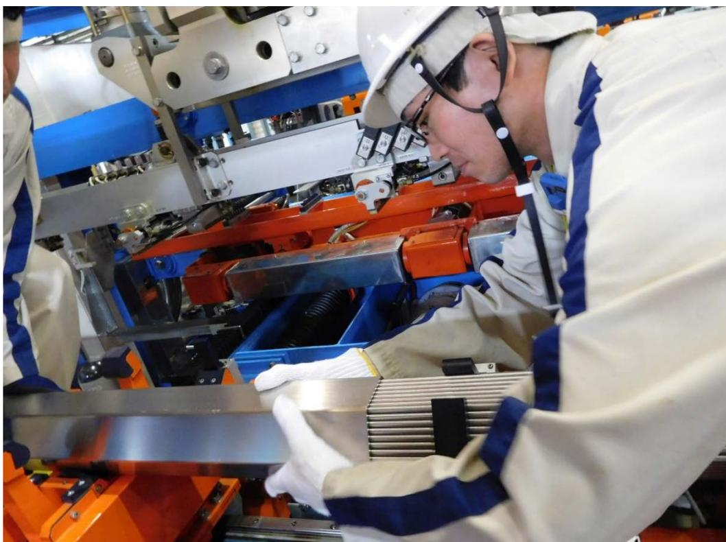
図 52 ラップ管挿入の様子 2
