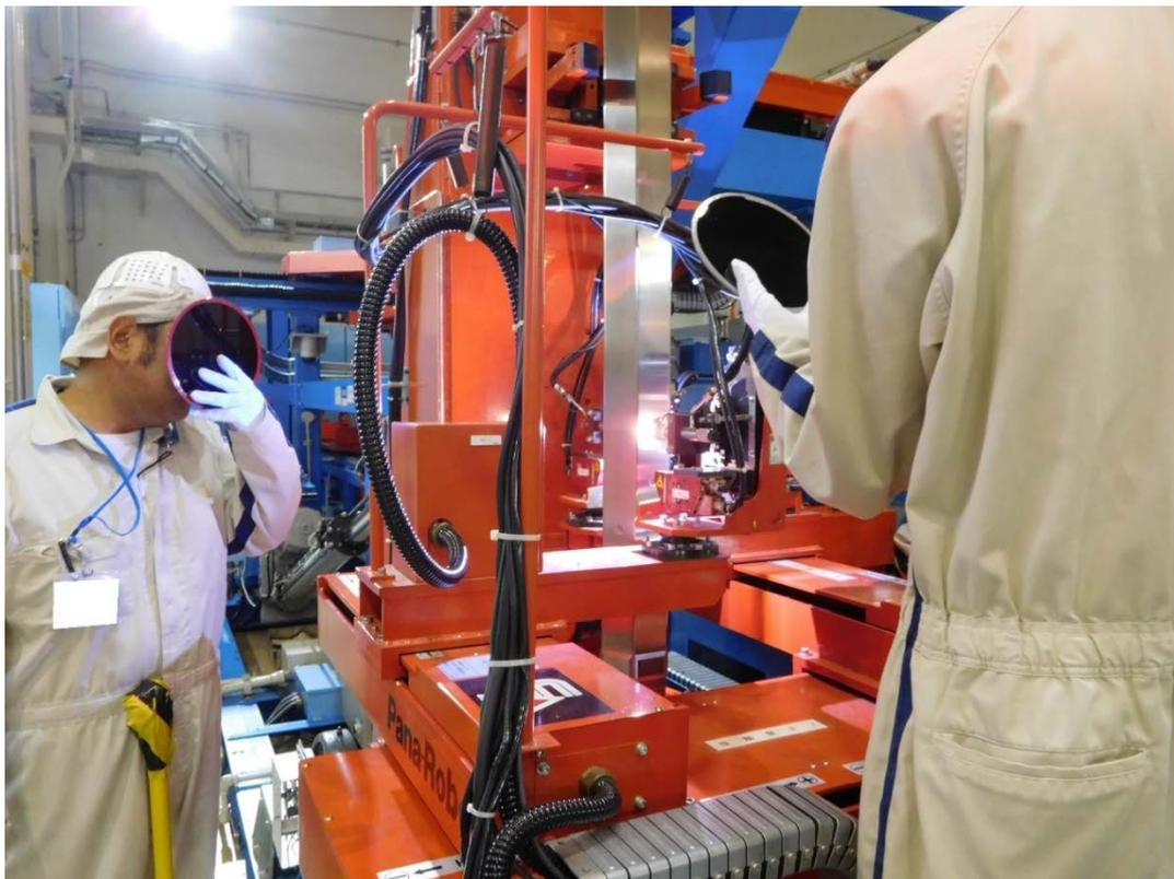
図 58 ラップ管・エントランスノズル溶接の様子 3
