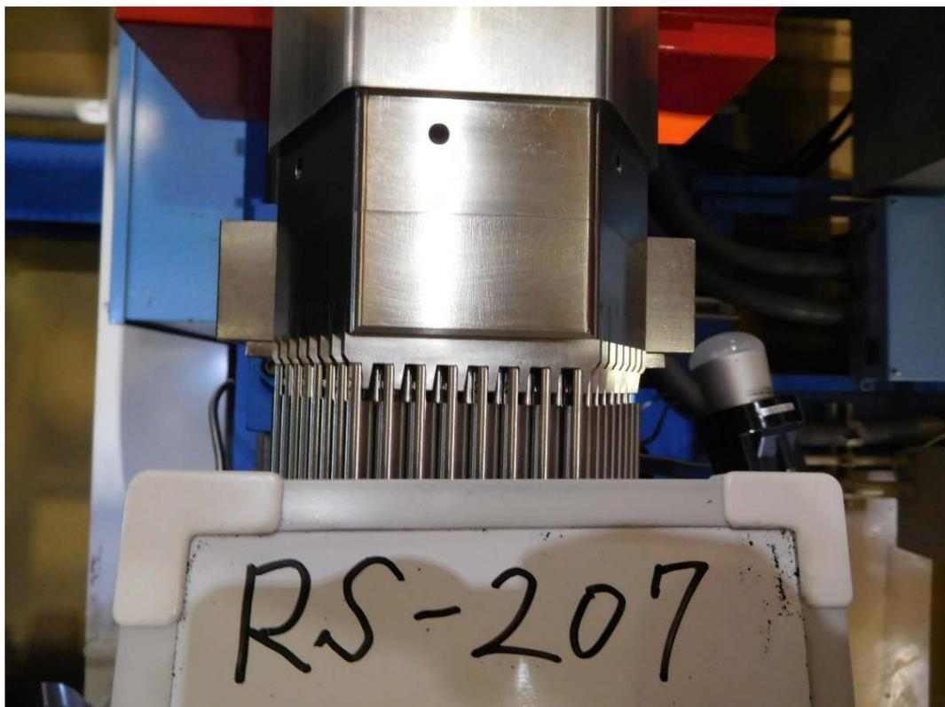
図 48 模擬燃料要素組込確認の様子 2
