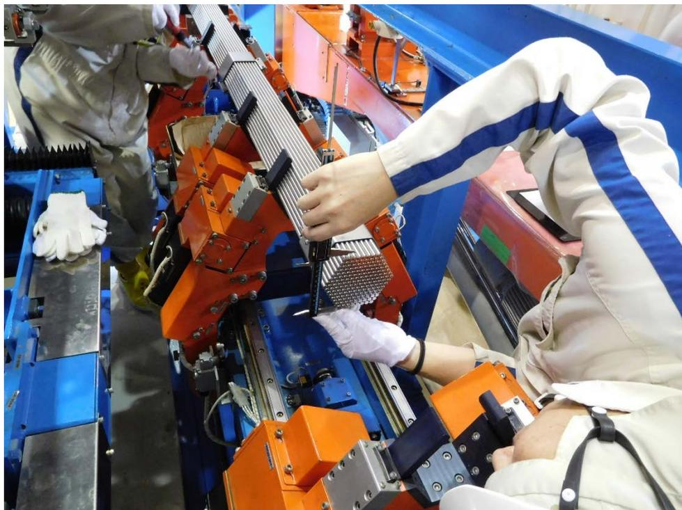
図 33 バンドル押さえ治具取付後ノギスによる寸法検査
