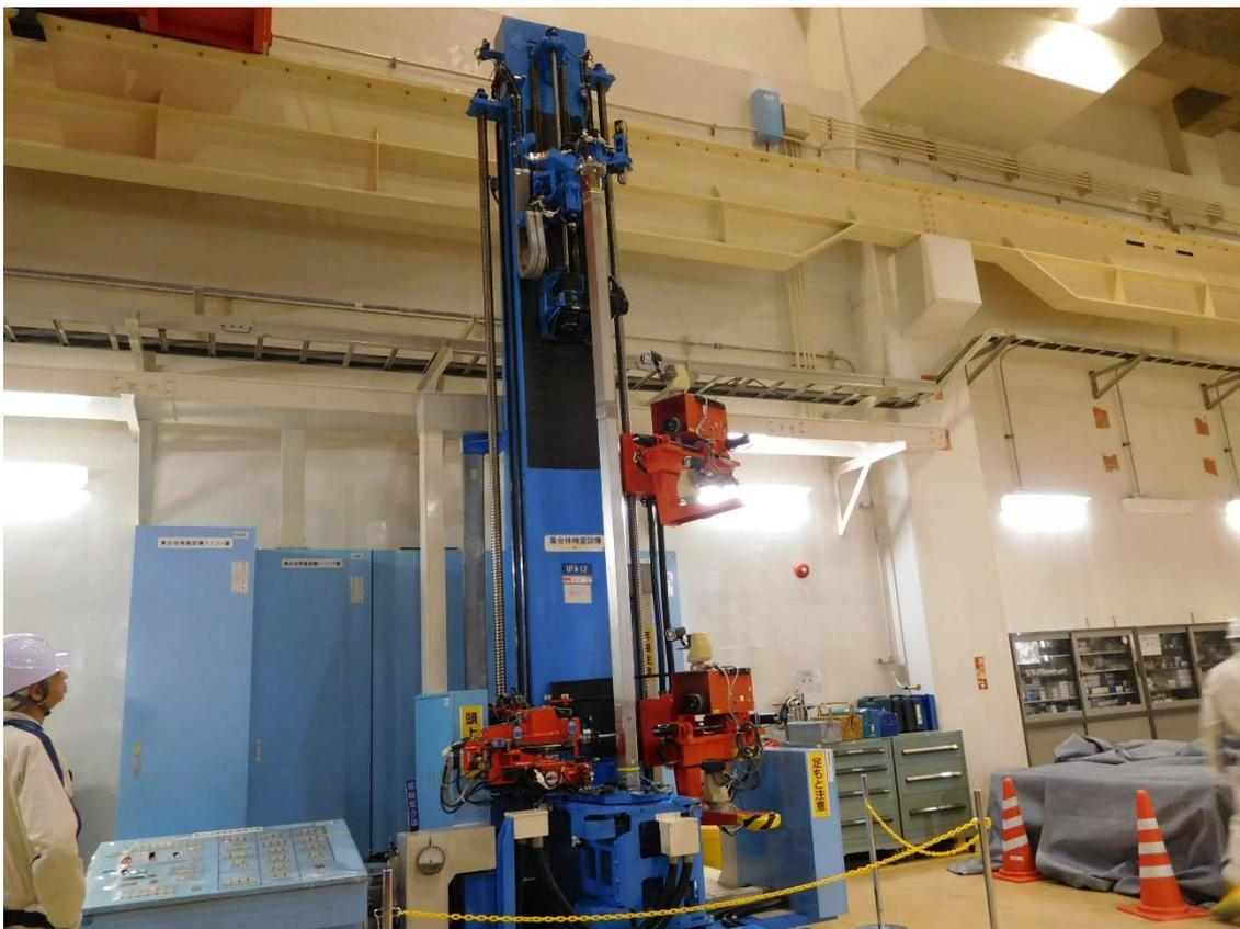
図 64 模擬燃料集合体外観検査、寸法検査の様子
