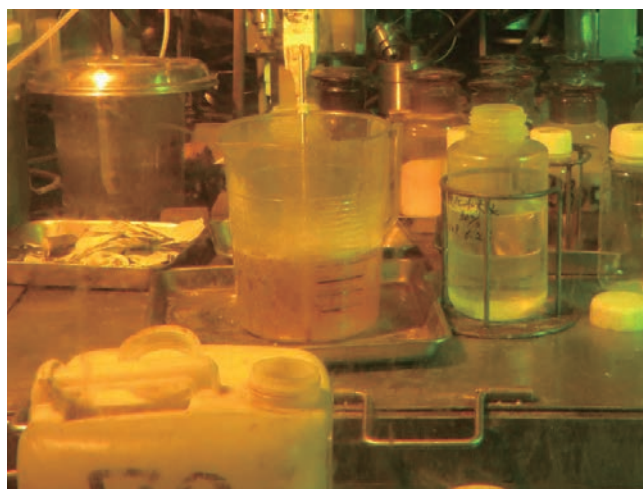
図 4 試験溶液（硝酸,乳酸）処理状況
