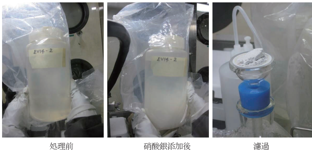
図 5 試験溶液（塩化物,硝酸）処理状況
