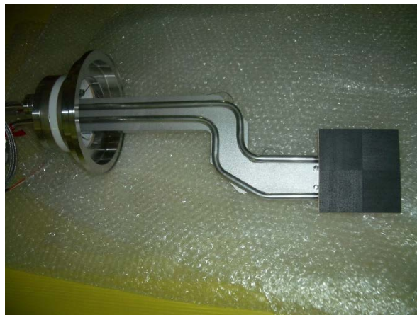
図 4.4-25 エレクトロンキャッチャー全体（建設時の新品の状態）
