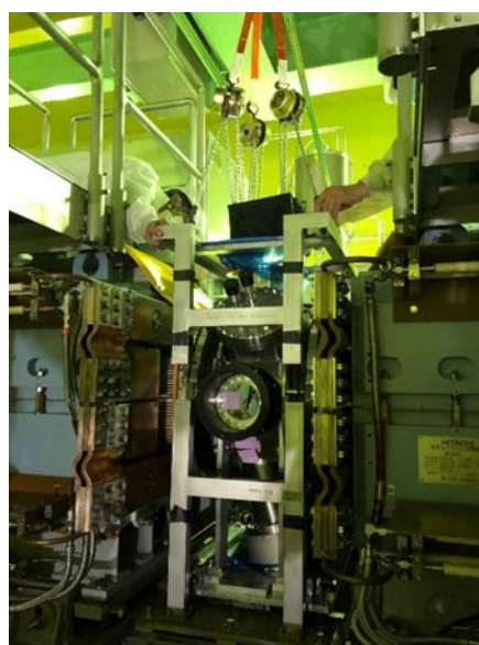
図 4.4-8 MWPM4 用架台取外し
