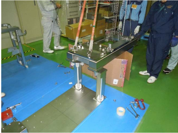
図 4.4-1 新架台ユニットの組立
