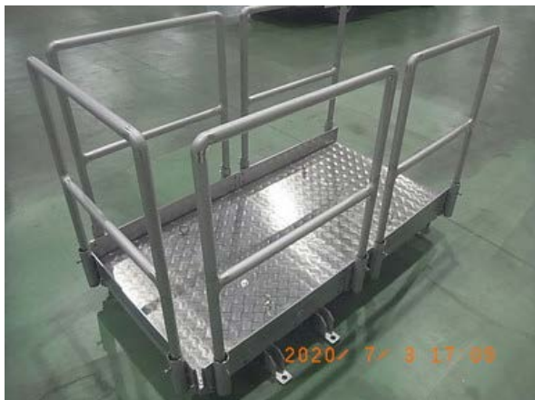
図 4.2-3 製作した作業台
