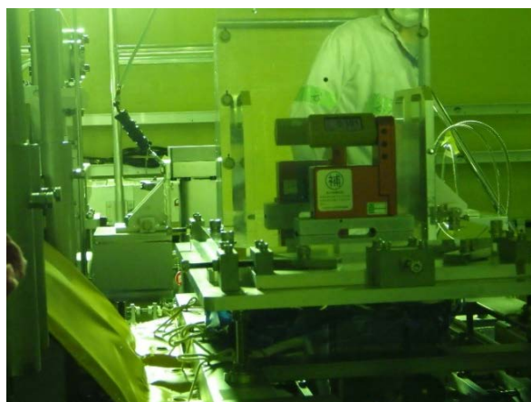
(D) MWPM4 ベースプレート傾斜測定
