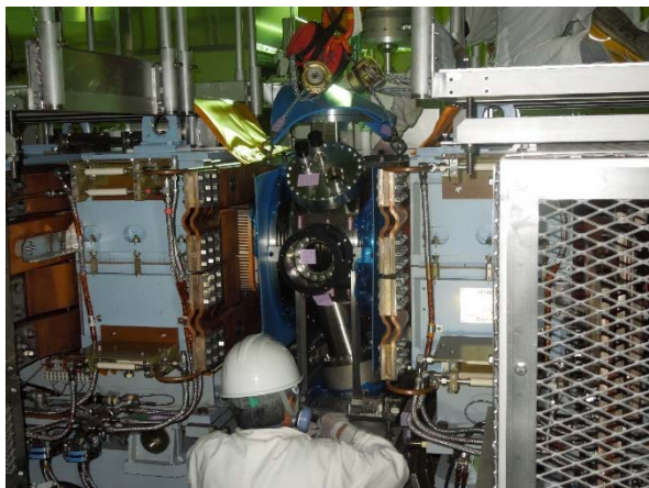
図 4.4-11 チャンバーBの取外し作業 (1)
