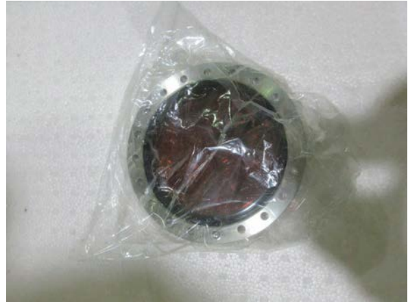
図 4.4-22 取外した W1 真空窓
