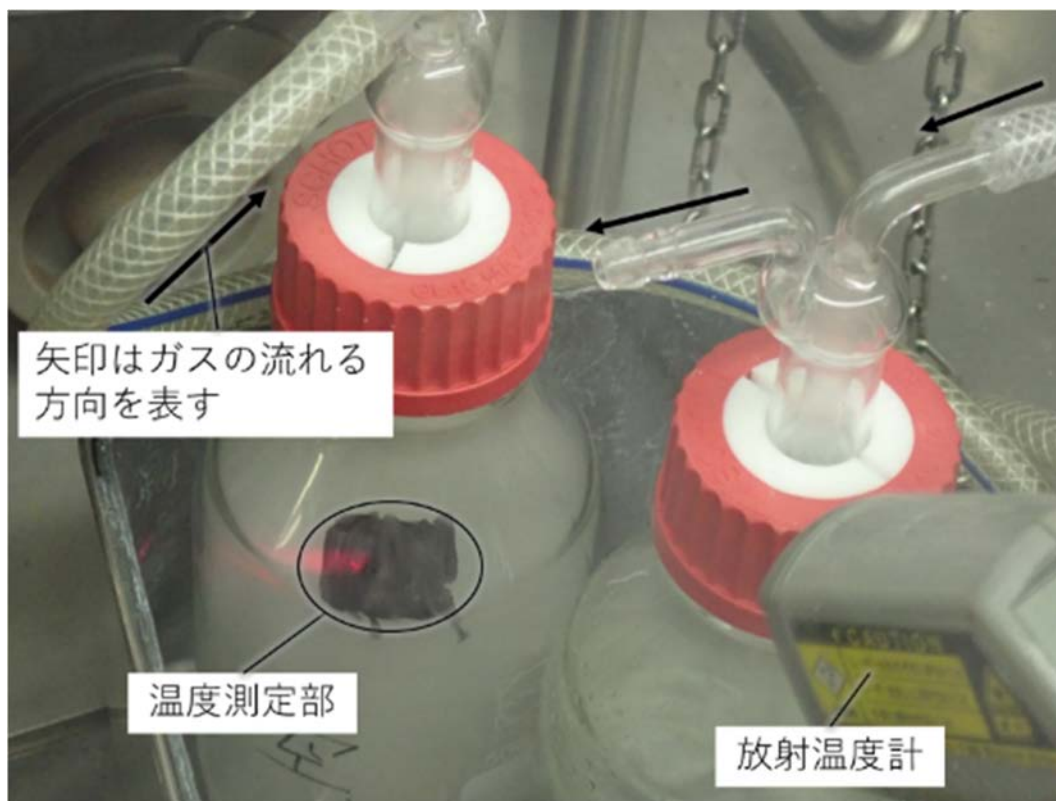
Photo 12 放射温度計での温度確認
