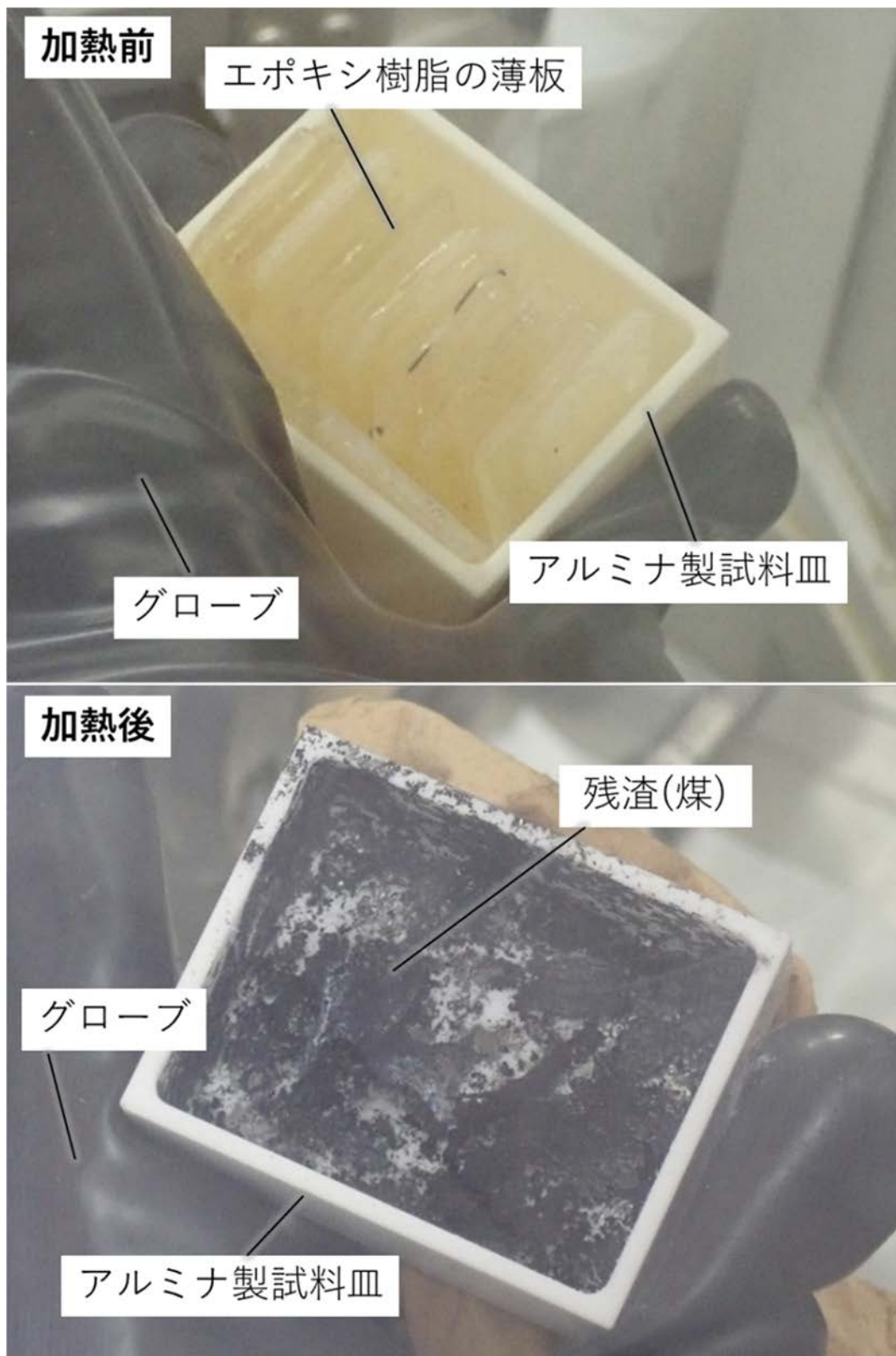
Photo 4 加熱前後のエポキシ樹脂（上：加熱前、下：加熱後）
