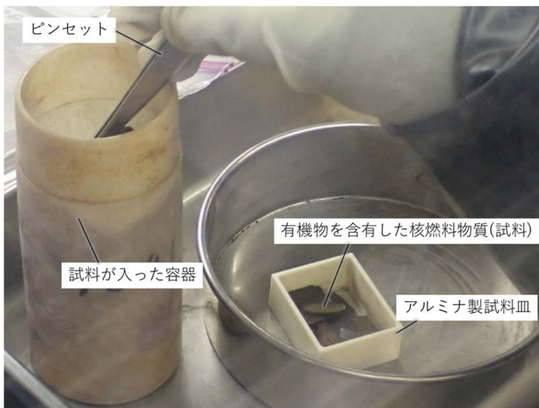
Photo 9 試料をアルミナ製試料皿に載せている様子
