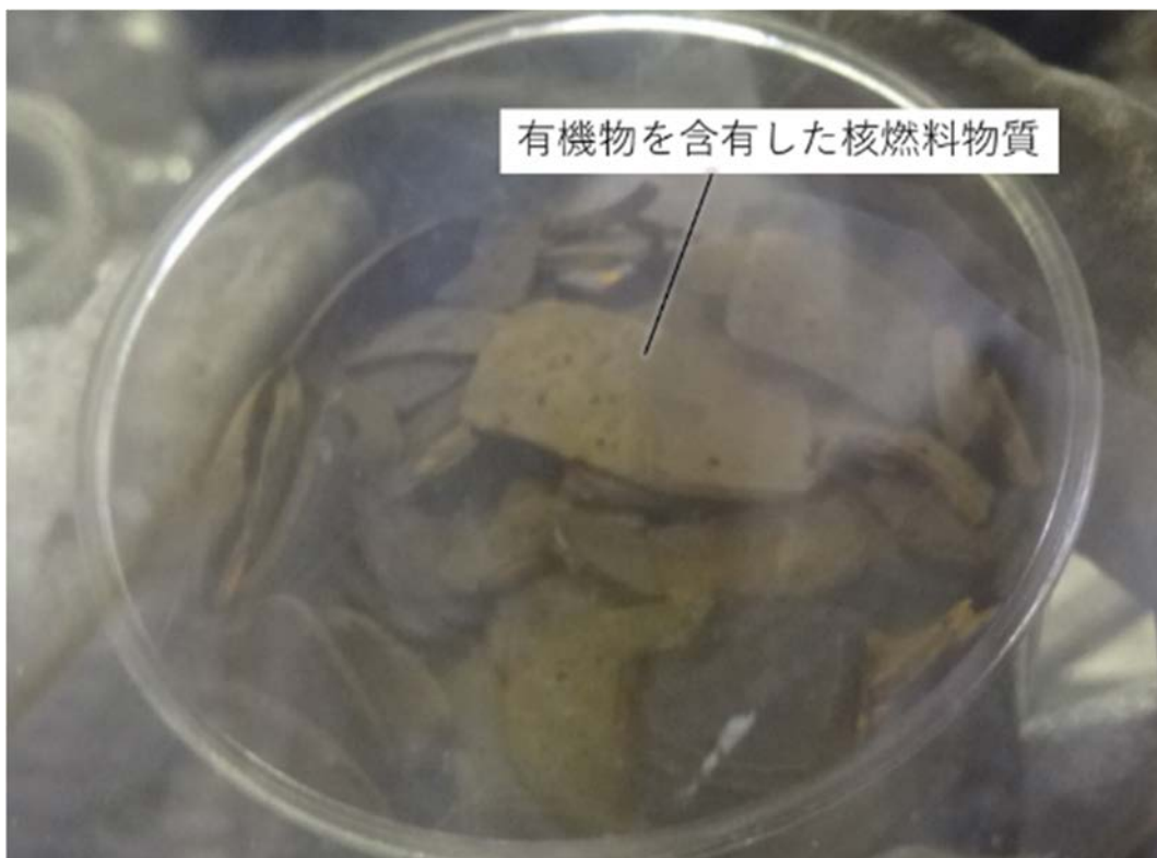
Photo 1 燃料研究棟の汚染・被ばく事故の原因となった有機物を含有した核燃料物質 (写真は大洗研究所燃料研究施設保全課の提供)
