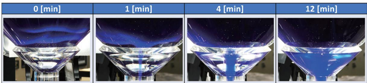
図 3.8 円錐炉底、ストレーナ形状 TVF3F における流下時の様子
