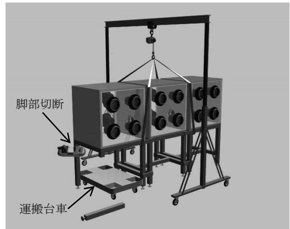
図-6.3.8 架台の切断
