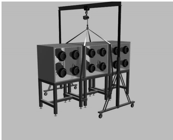
図-6.3.7 移動式門型クレーン設置
