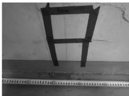
写真-12 作業状況 汚染検査 ダイレクト法汚染検査（106号室） 汚染検出部
