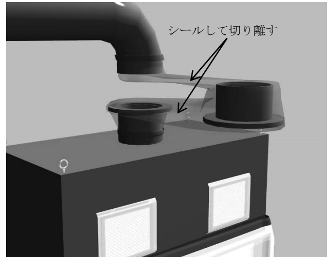
図-6.3.6 切断ダクトの切り離し
