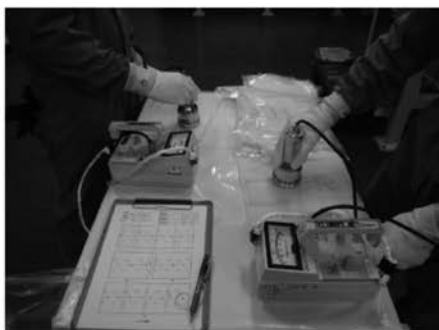
写真-7 作業状況 汚染検査 スミヤ法汚染検査測定
