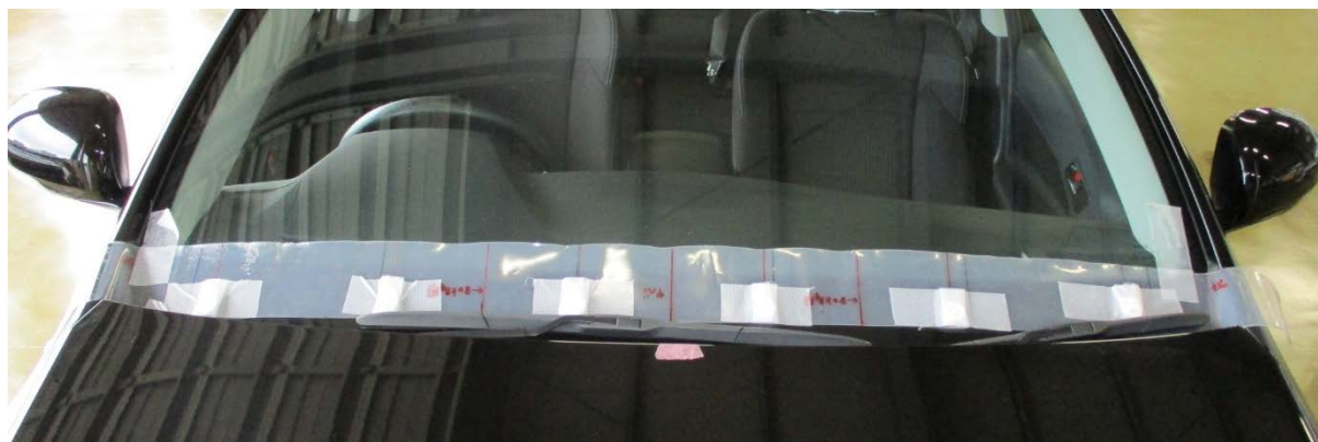
Fig. 2-19 ワイパー部に配置した模擬汚染線源 写真はセダンに設置した線源6個のもの
