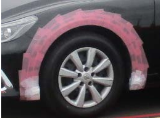
Fig. 2-14 タイヤのフェンダー側面に装着した模擬汚染線源（2個）
