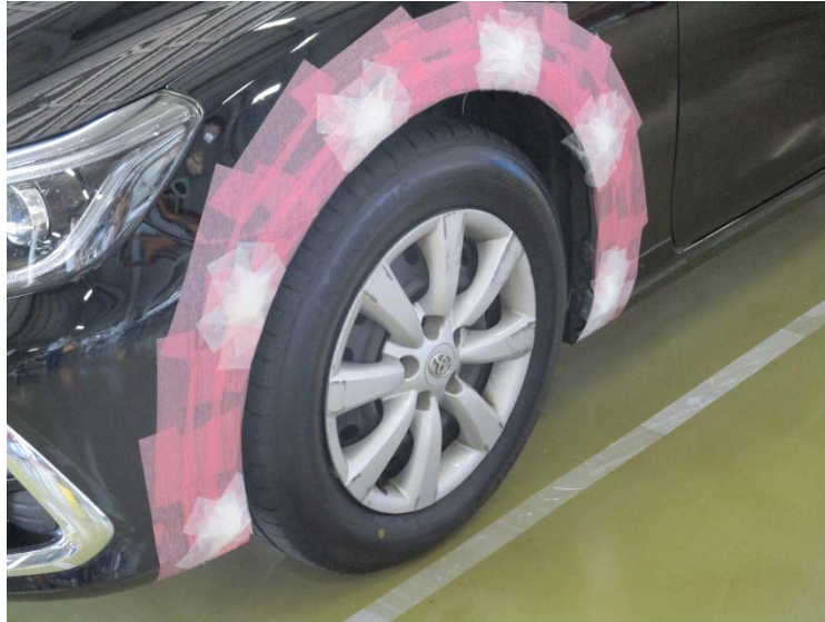
Fig. 2-12 タイヤ接地面に近いフェンダー側面に装着した模擬汚染線源（6個）
