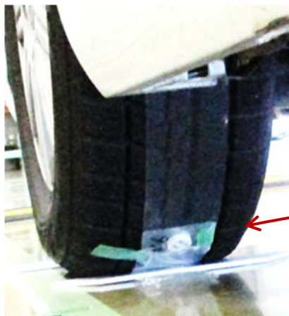
Fig. 2-8 タイヤ接地面に装着した模擬汚染線源
