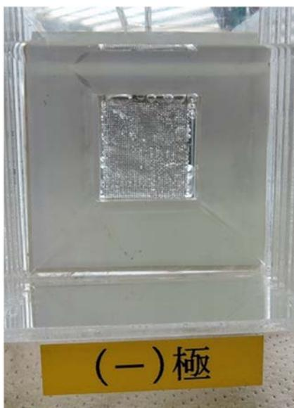
図 4-1 陰極に発生した気泡の様子
