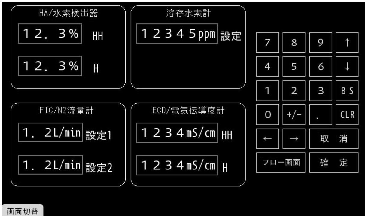
設定したい表示枠をタッチすると、枠が点滅する。テンキーにより設定値を入力する。
