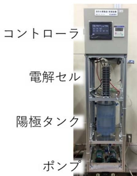
図 5-4 溶存水素濃度制御装置の外観写真
