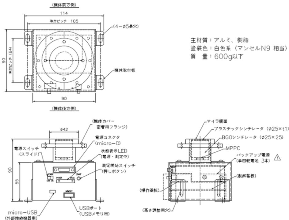
Fig. 6-17 ホススイッチ型検出器の図面
