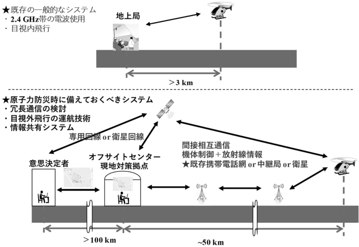
Fig. 6-1 既存の無人機によるシステムと原子力災害時に備えるべき無人機システムのイメージ
