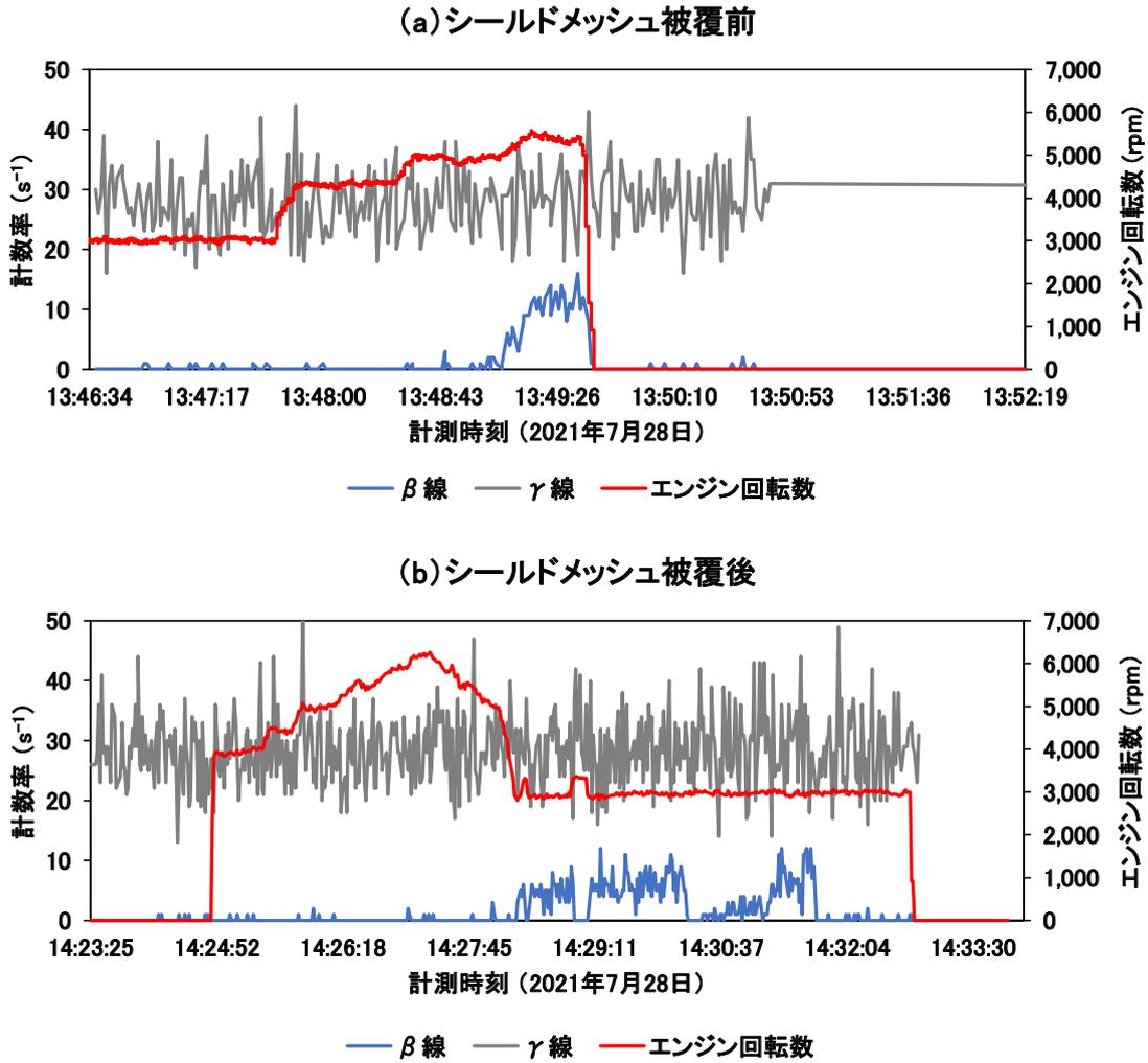
**Fig. 6-19 エンジン回転数上昇に伴うノイズの影響 (地上試験時)**
