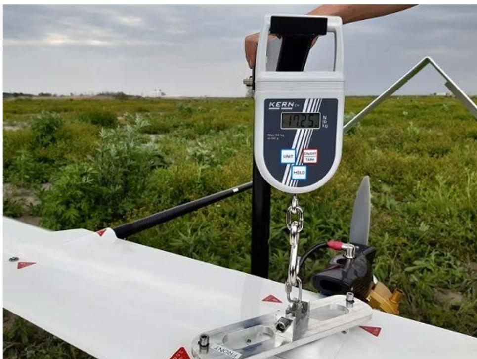
Fig. 6-15 空虚重量測定例
