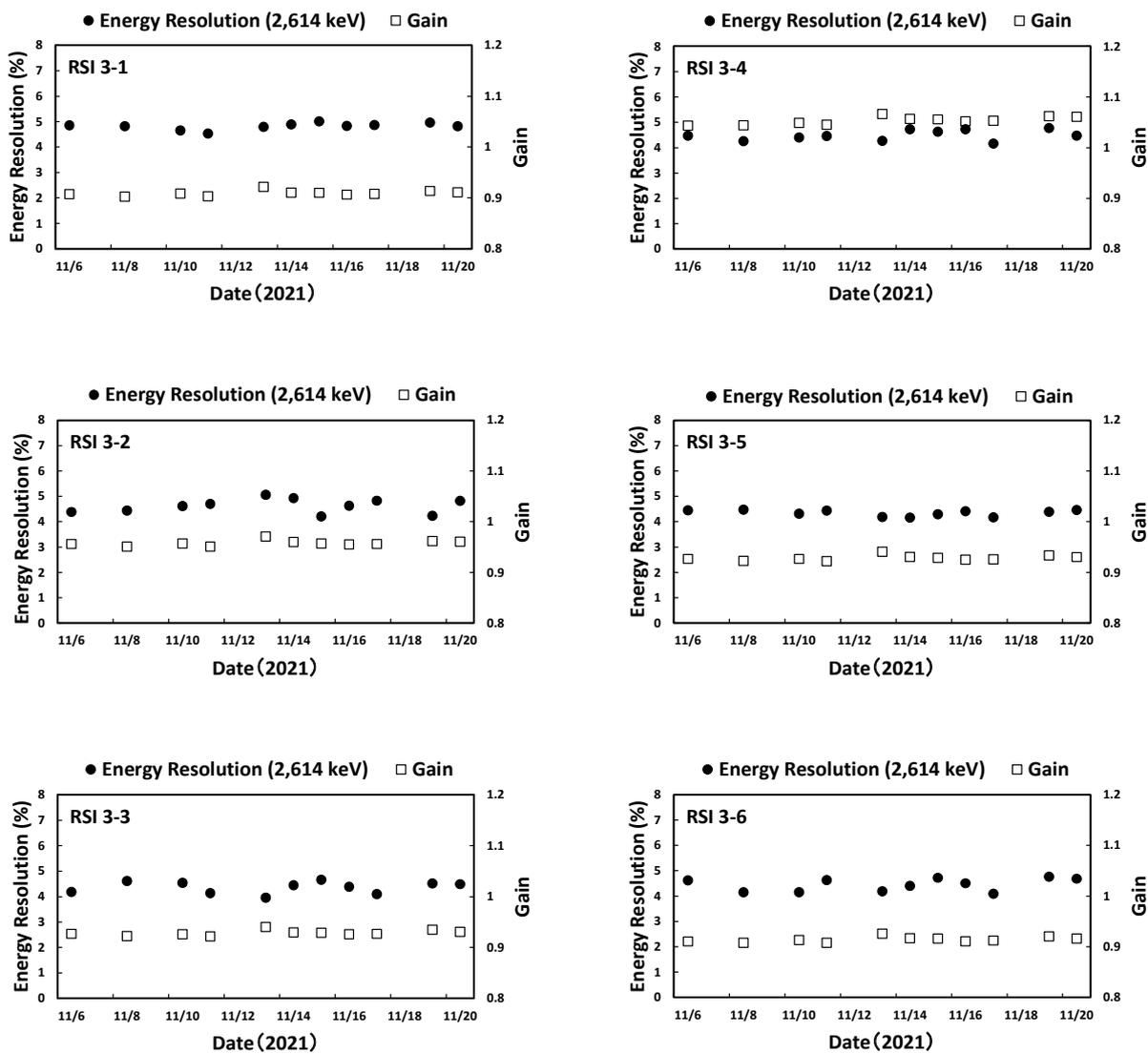
Fig. 2-5 システムのエネルギー分解能及び Gain の推移
