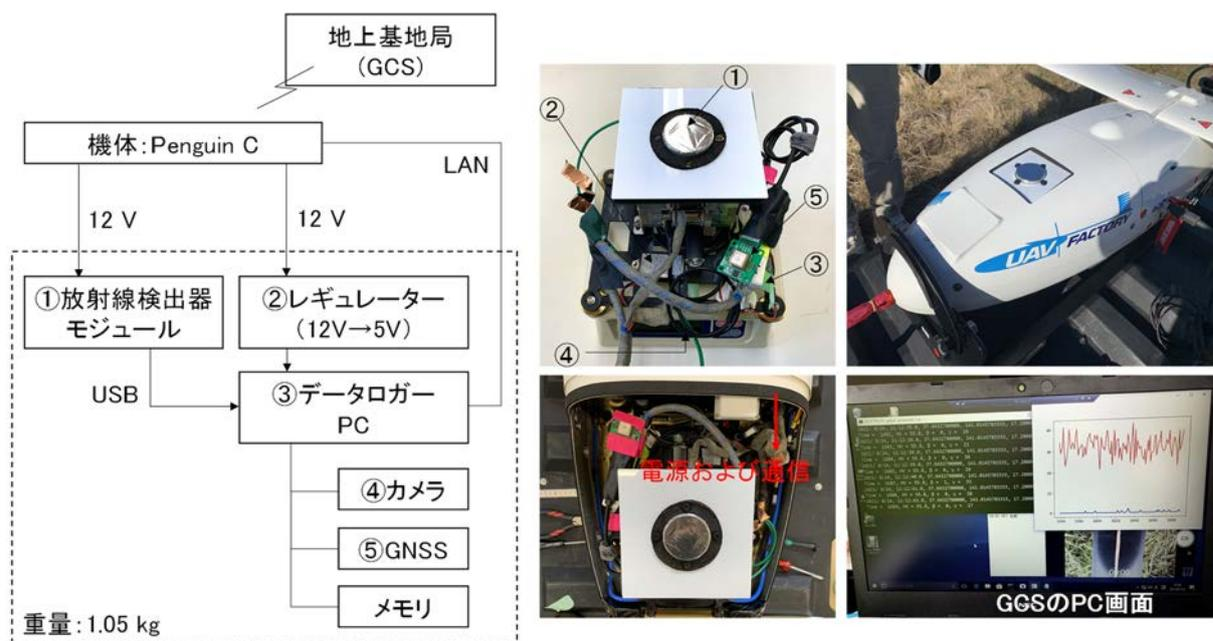
Fig. 6-16 放射線測定システム試作機の概要及び外観
