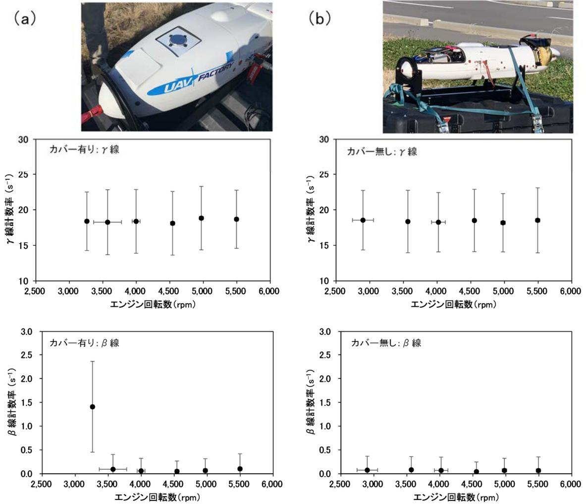
Fig. 6-20 カバーの有無による電磁ノイズの影響
