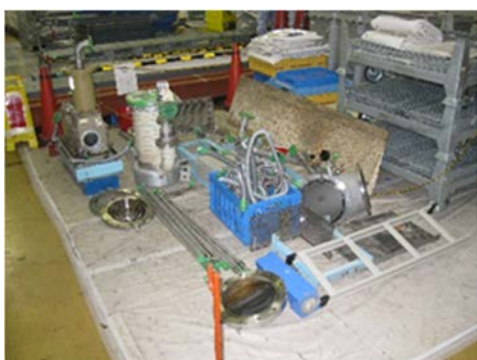
(5) 撤去した小型焼結炉付属機器
