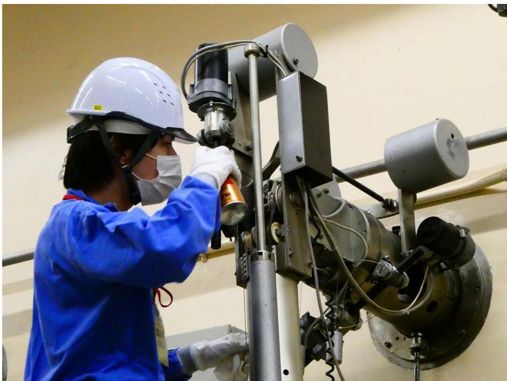
Fig. 5.3.3 M/S マニプレータ保守点検 (操作室)
