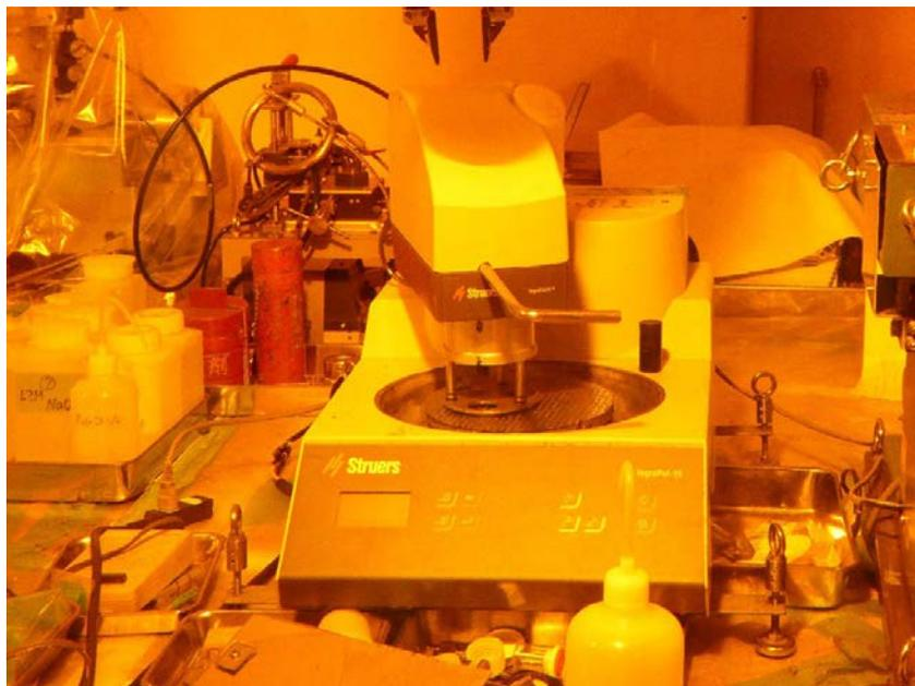
Fig. 2.1.6 研磨装置 テグラポール 15 (No.1 セル)
