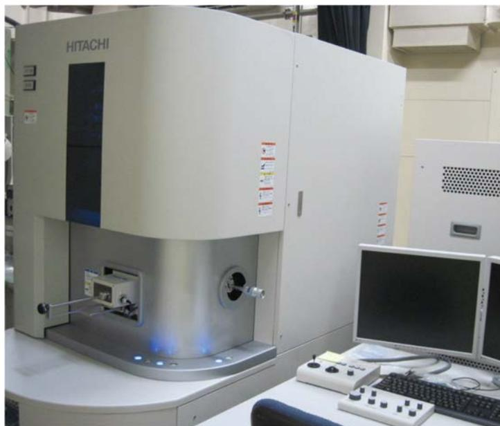
Fig. 2.1.19 集束イオンビーム加工観察装置 (FIB)
