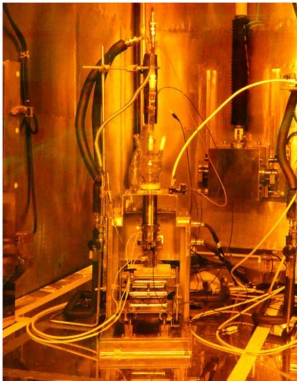
Fig. 2.1.14 伝熱面腐食試験装置 (No.4 セル)
