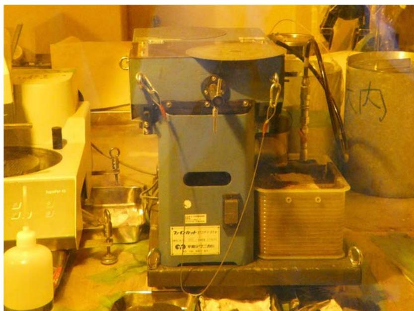
Fig. 2.1.9 切断機 ファインカットセーフティ (No.2 セル)
