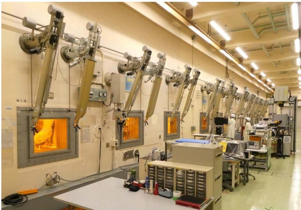
Fig. 2.1.2 コンクリートセル外観
