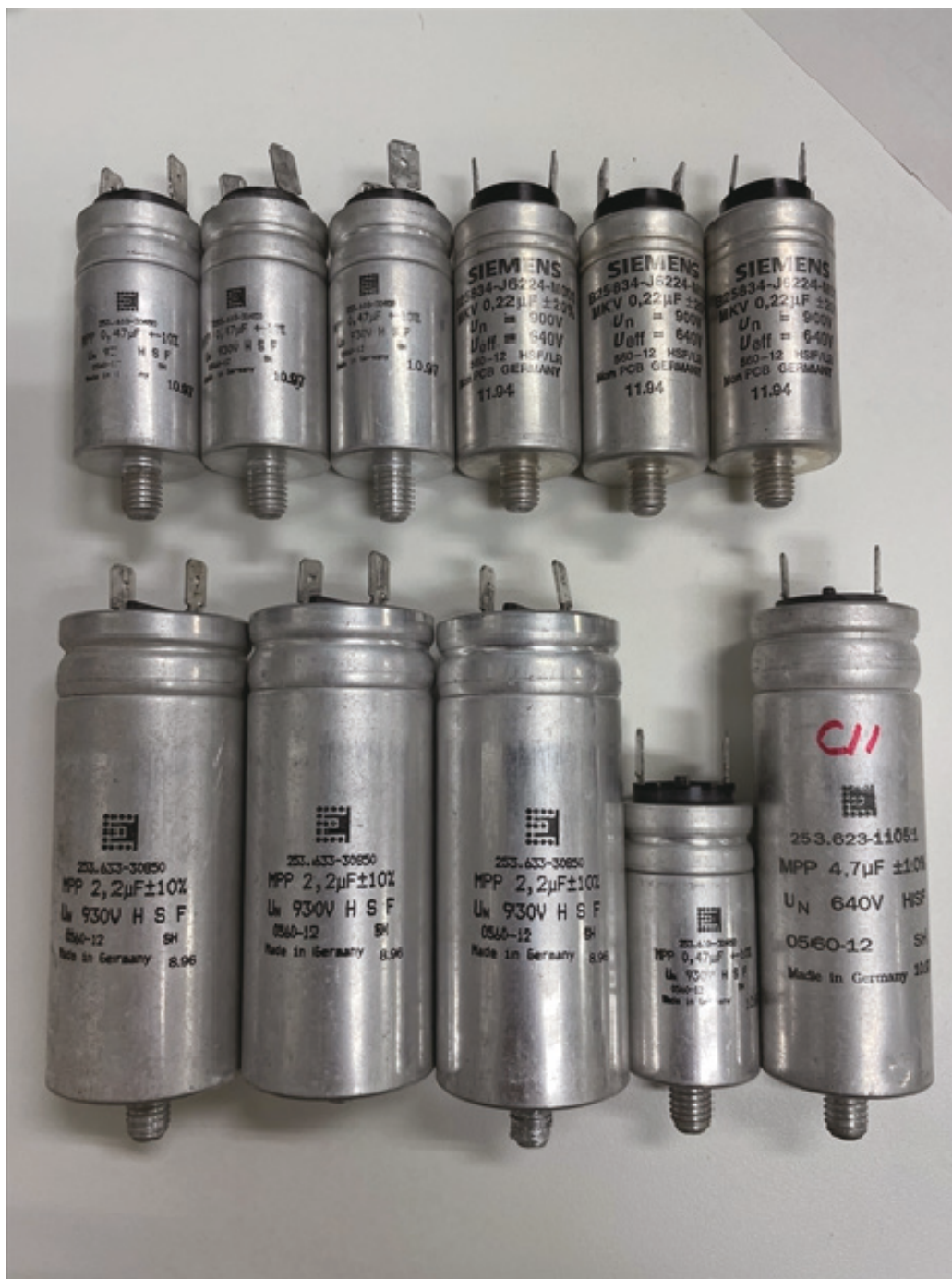
図 37：調査対象電源 A で発見された PCB 廃棄物の疑いがあるコンデンサ
