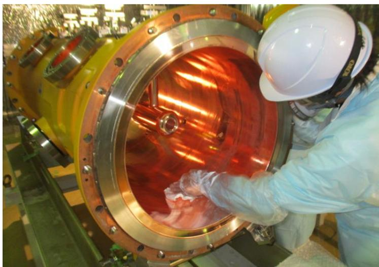
図 10 空洞内表面洗浄の様子
